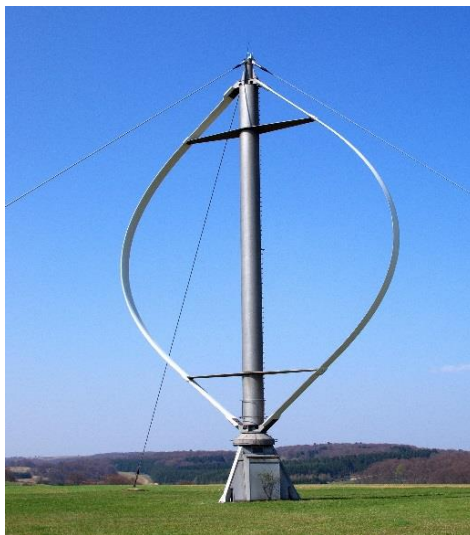
Εικόνα 3.2: Ανεμογεννήτρια καθέτου άξονα (VAWT-vertical axis wind turbine)
