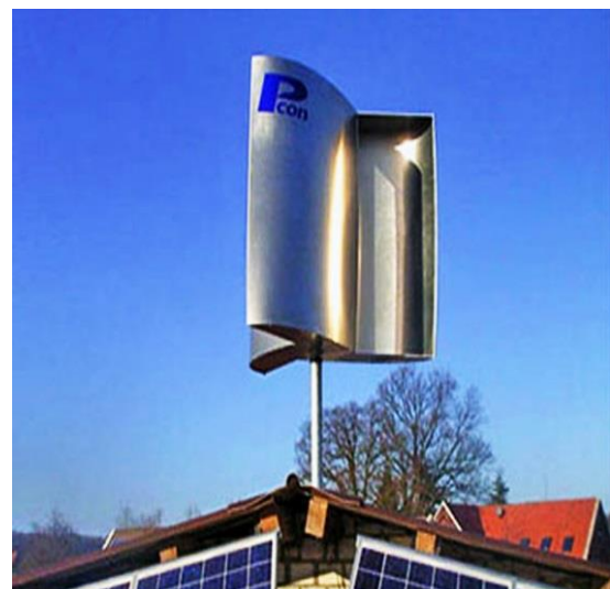
Εικόνα 3.2: Ανεμογεννήτρια καθέτου άξονα (VAWT-vertical axis wind turbine)
