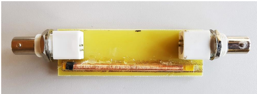
Σχήμα 38 Ο μαγνητικός αισθητήρας fluxgate που κατασκευάστηκε στο εργαστήριο
