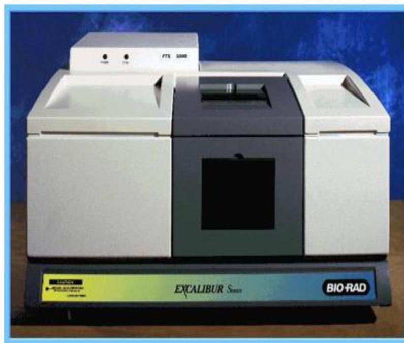
Εικόνα 3.4: Το φασματοφωτόμετρο FTIR Biorad FTS 3000MX Excalibur Series της εταιρείας BIO-RAD Laboratories.
