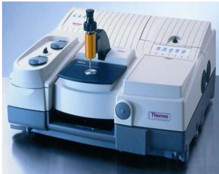
Εικόνα 3.3: Φασματοφωτόμετρο υπερύθρου μετασχηματισμού Fourier, Nicolet 6700 thermoscientific, διακριτικής ικανότητας 4\text{cm}^{-1} [2]
