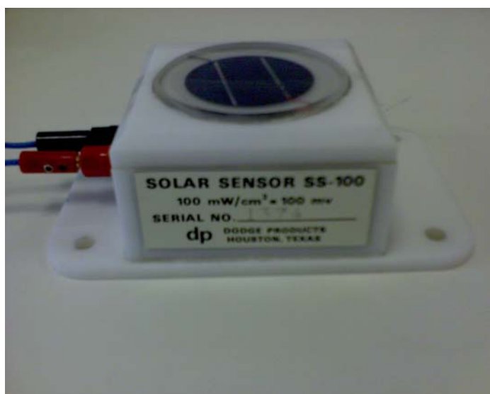
Εικόνα 16: Πρότυπο όργανο μέτρησης έντασης ακτινοβολίας
