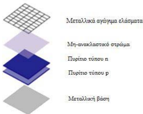
Σχήμα 9 : Δομή φωτοβολταϊκού στοιχείου [ 16 ]
