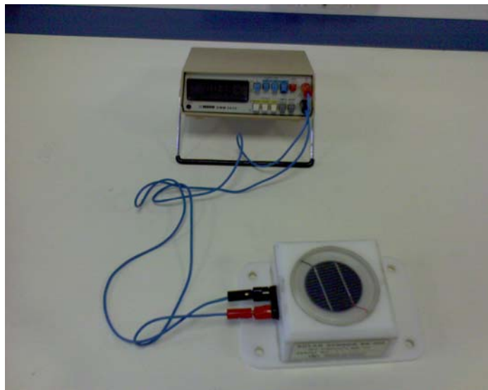
Εικόνα 15: Πρότυπο όργανο μέτρησης έντασης ακτινοβολίας
