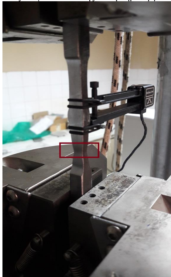
Εικόνα 28 Δημιουργία λαιμού κατά τον εφελκυσμό δοκιμίου High Tensile Steel
