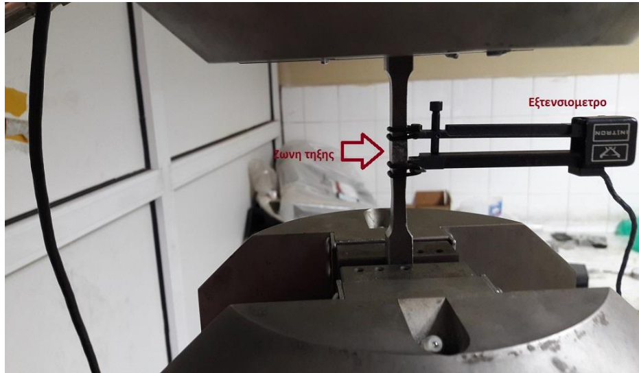
Εικόνα 27 Εκτενσιόμετρο κατά τη διάρκεια του εφελκυσμού
