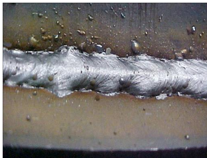
Εικόνα 4. Ατελής Τήξη στη Συγκόλληση
