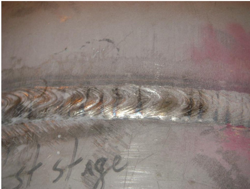
Εικόνα 10.Ελασματοποιήσεις στη Συγκόλληση
