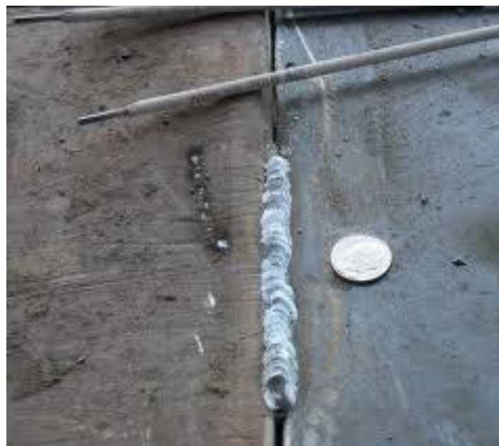
Εικόνα 5.Χτυπήματα τόξου στη Συγκόλληση
