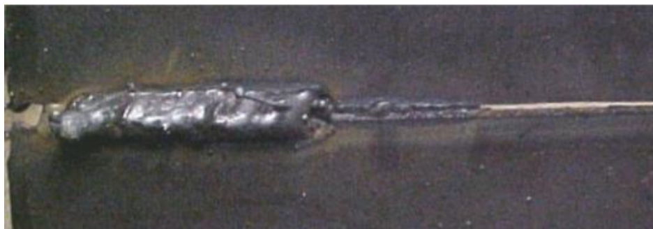
Εικόνα 3.Ανεπαρκής Διείσδυση της Κόλλησης
