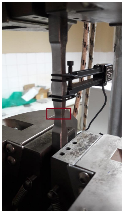
Εικόνα 29 Δημιουργία λαιμού κατά τον εφελκυσμό δοκιμίου Mild Steel
