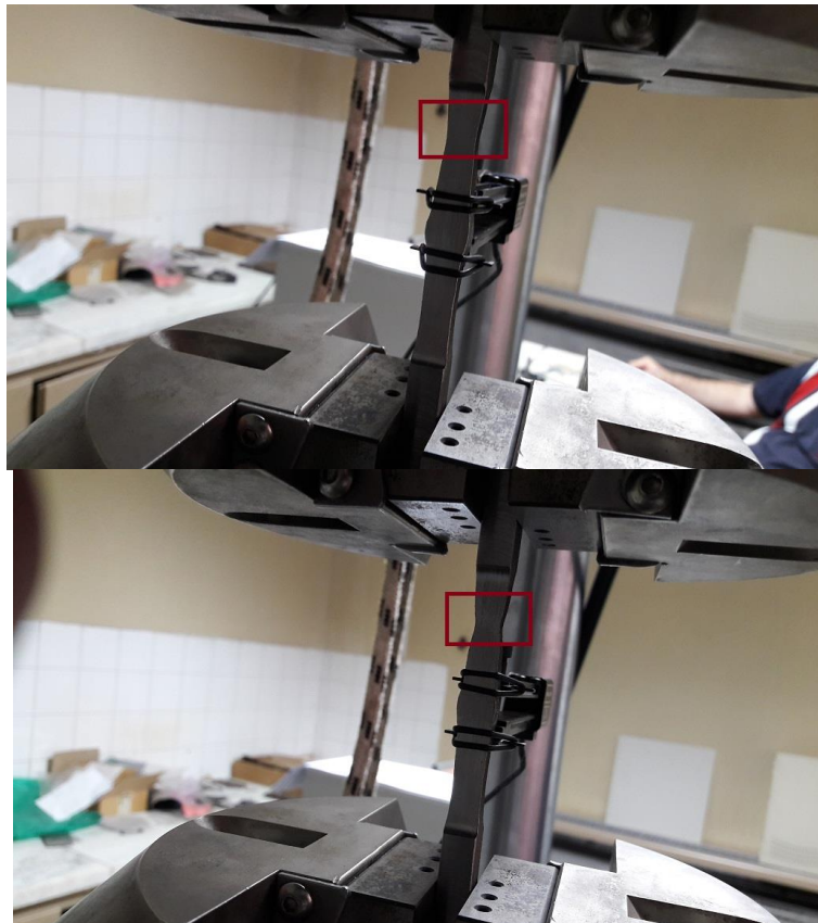
Εικόνα 29 Δημιουργία λαιμού κατά τον εφελκυσμό δοκιμίου Mild Steel
