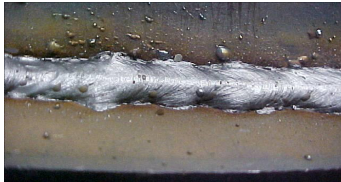
Εικόνα 6. Υπερπληρώσεις στην ένωση της συγκόλλησης
