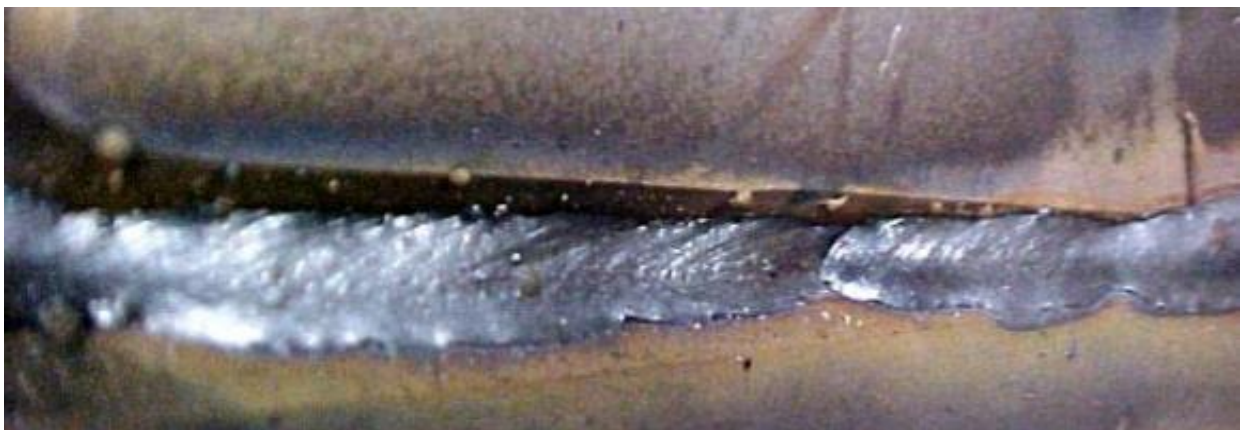
Εικόνα 9.Υποπληρώσεις στη Συγκόλληση
