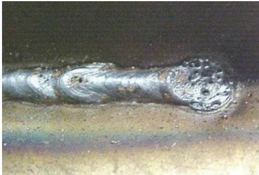
Εικόνα 11. Αποφλοιώσεις στη Συγκόλληση
