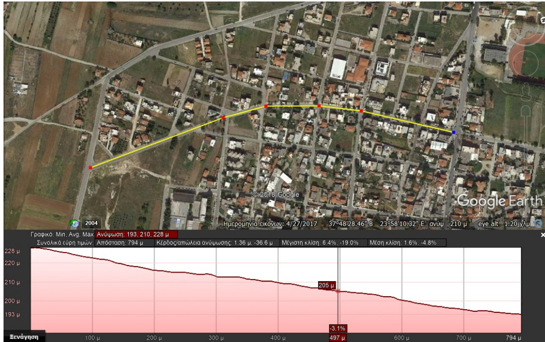
Εικόνα 87: Μηκοτομή της οδού Ανθυπολοχαγού Παναγιωταράκου
