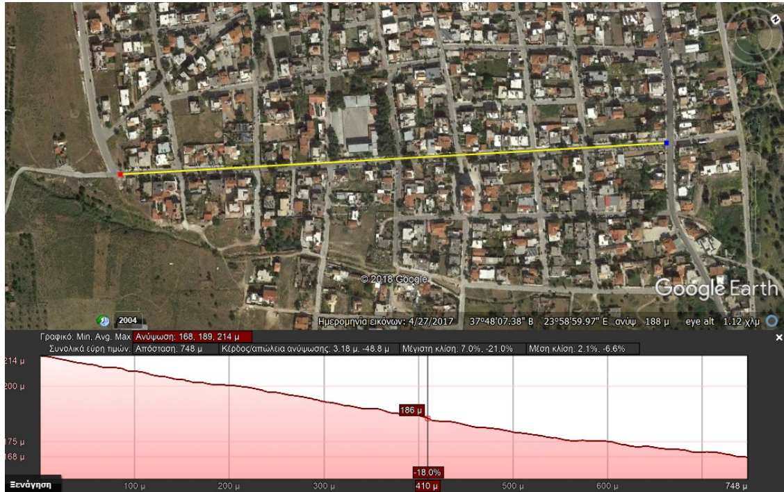
Εικόνα 93: Μηκοτομή της οδού Παύλου Μελά
