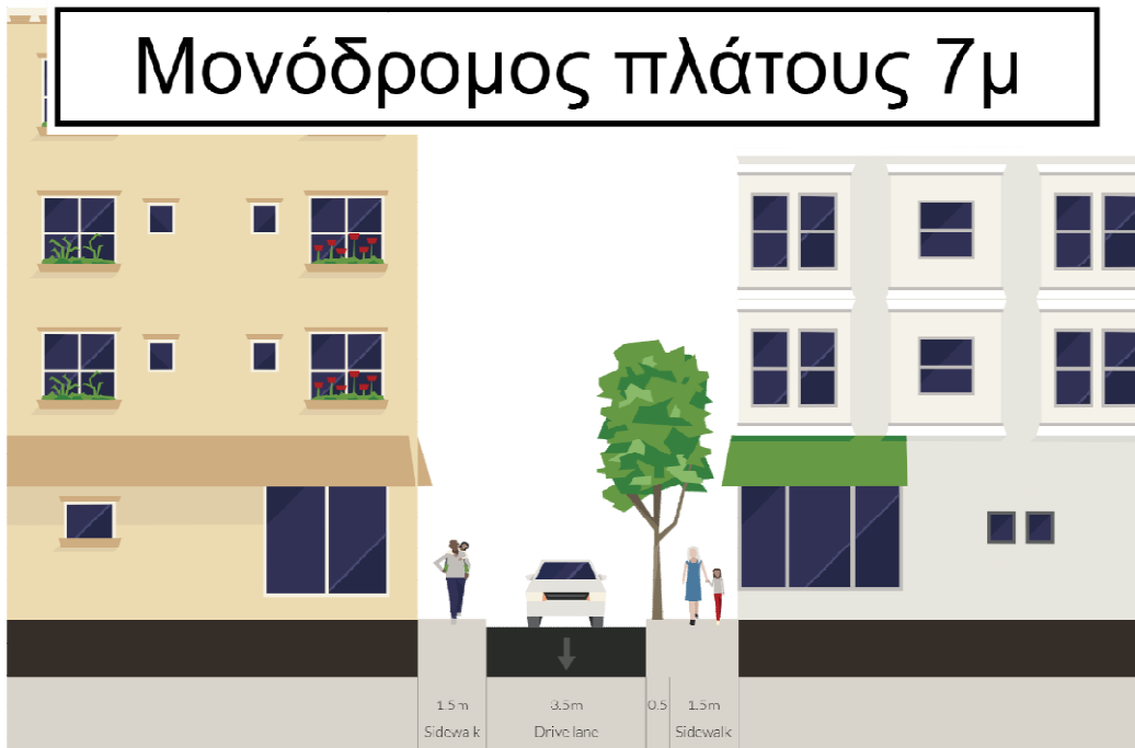
Εικόνα 111: Προτεινόμενη διατομή για διαπλάτυνση μονοδρόμου 7 μ.
