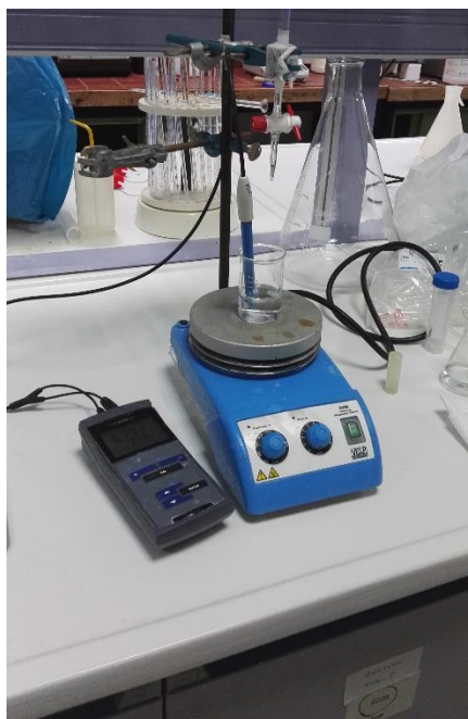
Εικόνα 3.12 Μέτρηση αλκαλικότητας με τιτλοδότηση
