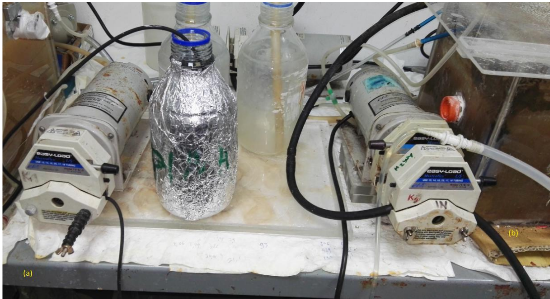
Εικόνα 3.3 Αντλίες χλωρίωσης (a) και ανακυκλοφορίας (b)
