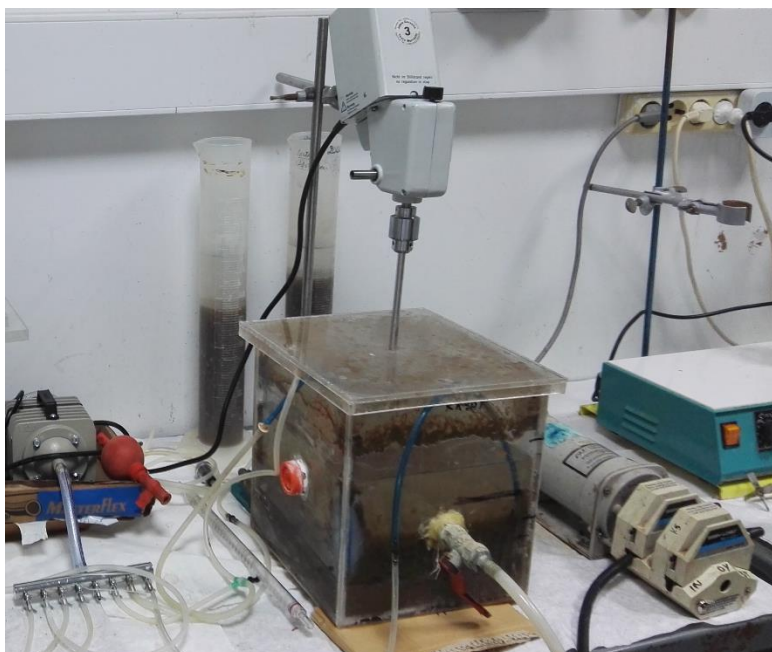
Εικόνα 3.1 Αντιδραστήρας SBR στη φάση καθίζησης
