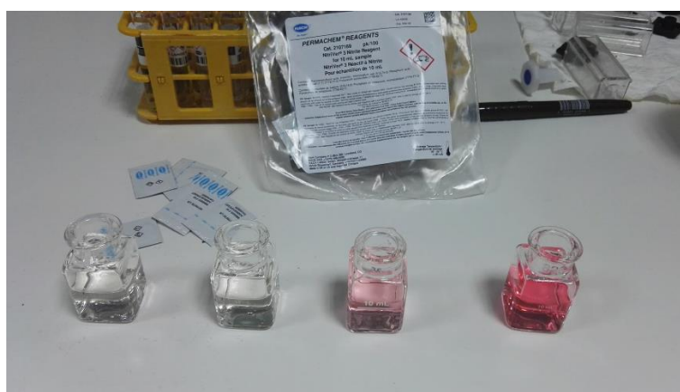
Εικόνα 3.10 Μέτρηση νιτρώδους αζώτου NO 2 -N
