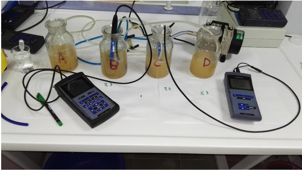
Εικόνα 3.4 Αντιδραστήρες batch με ρύθμιση pH
