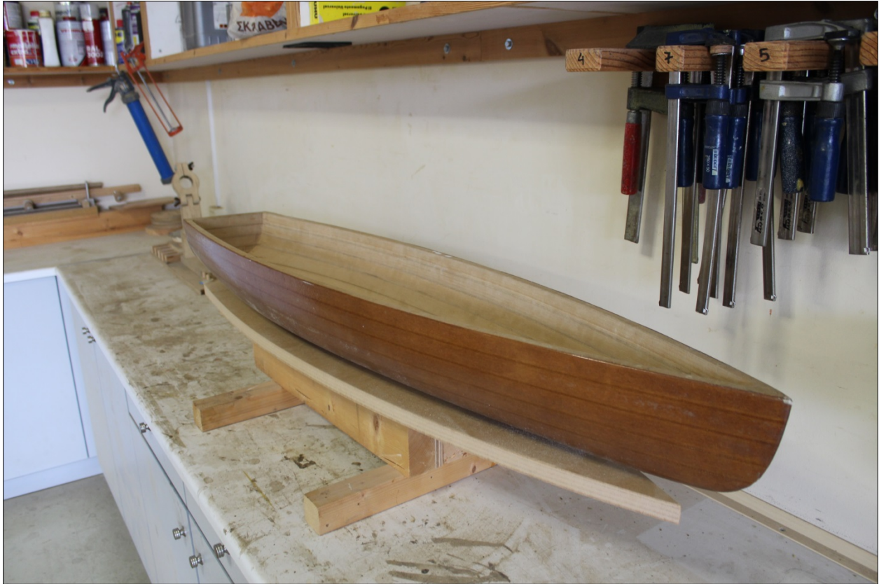
Εικόνα 7.4 : Επίστρωση υαλονήματος και ρητίνης στην επιφάνεια του μοντέλου
