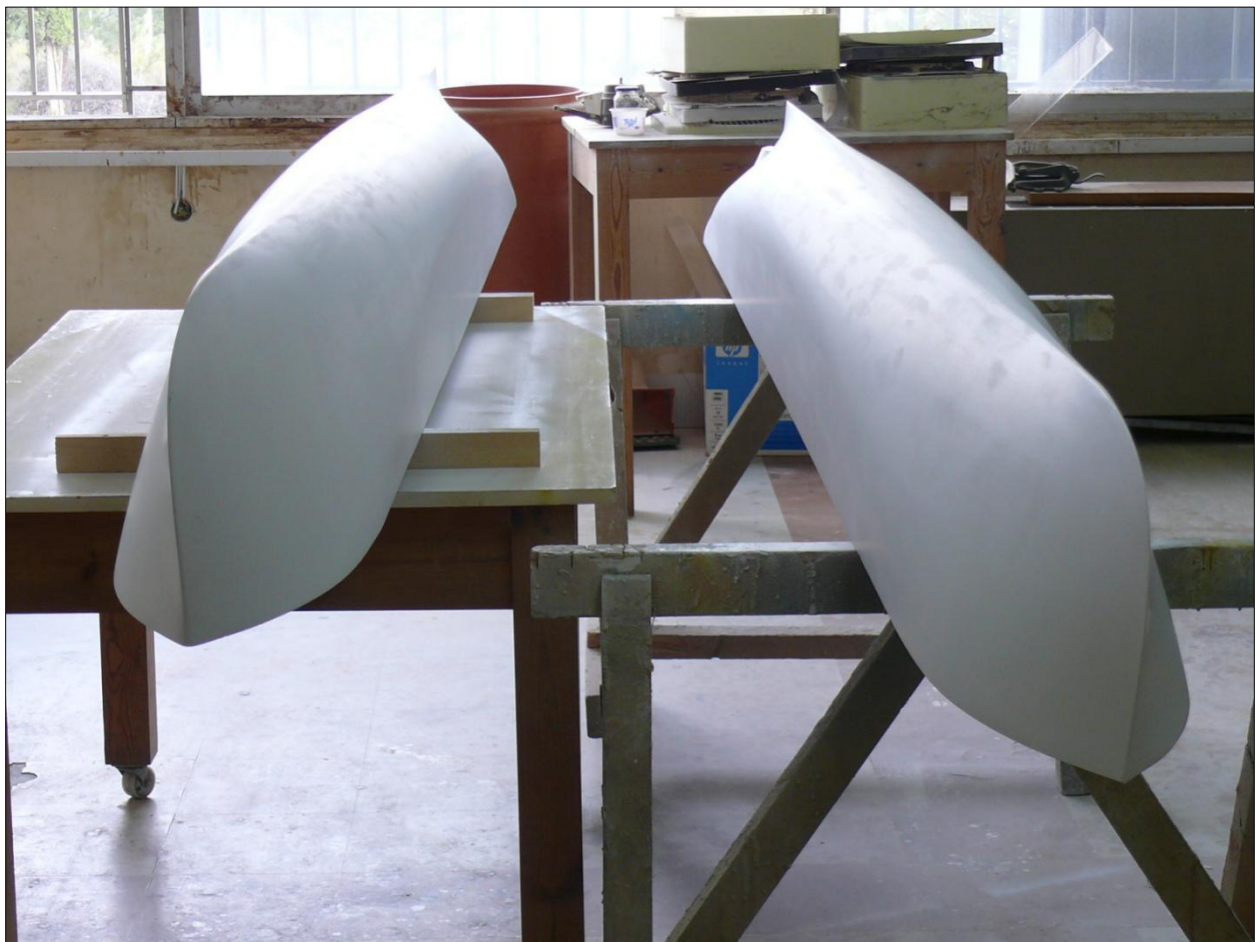
Εικόνα 6.1: Εφαρμογή υποστρώματος στο εξωτερικό της γάστρας
