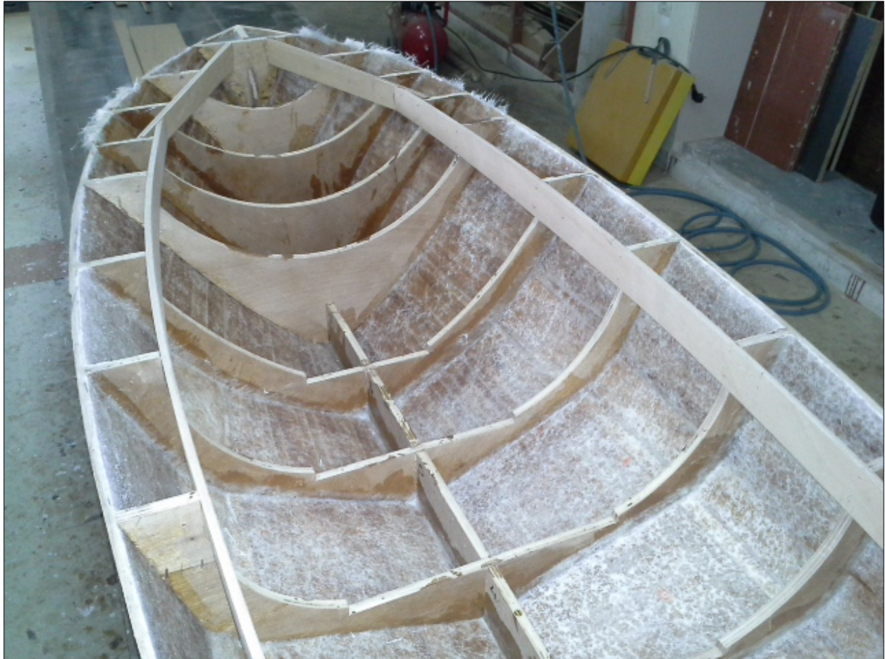
Εικόνα 2.3: Στρώση υαλονήματος στο εσωτερικό της γάστρας
