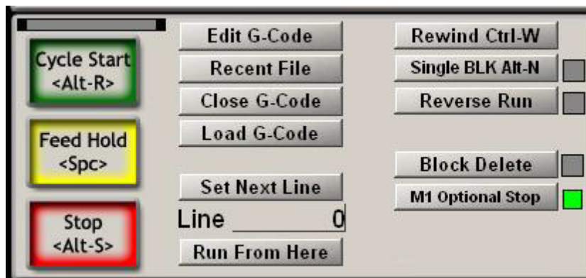
Εικόνα 5.7: Δυνατότητα παρέμβασης στη διαδικασία κοπής από το μενού του ελεγκτή
