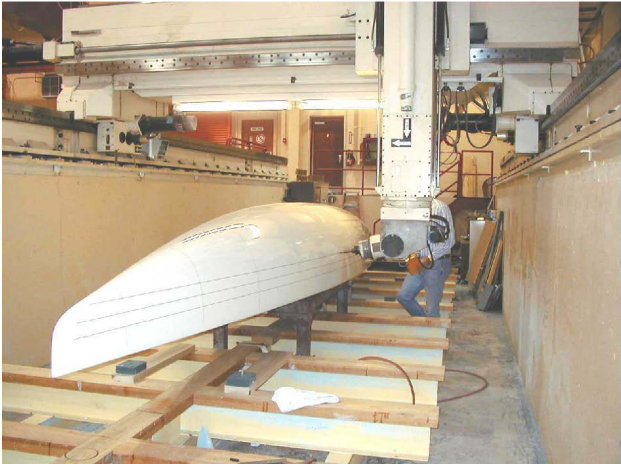
Εικόνα 2.16: Χάραξη ισάλων στο μοντέλο μέσω μηχανής CNC.
