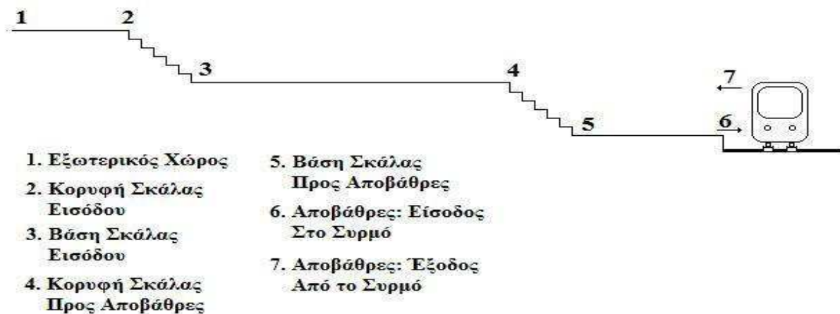
Σχήμα 42 Τα χαρακτηριστικά σημεία των Σταθμών Μετρό, όπου έγιναν οι μετρήσεις
