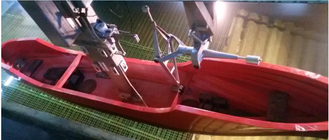
Εικόνα 10-Πειραματικό μοντέλο C_b=0.7 σε δοκιμή αντίστασης, κατάσταση \Delta=163.3 kg, T=0.163 m
