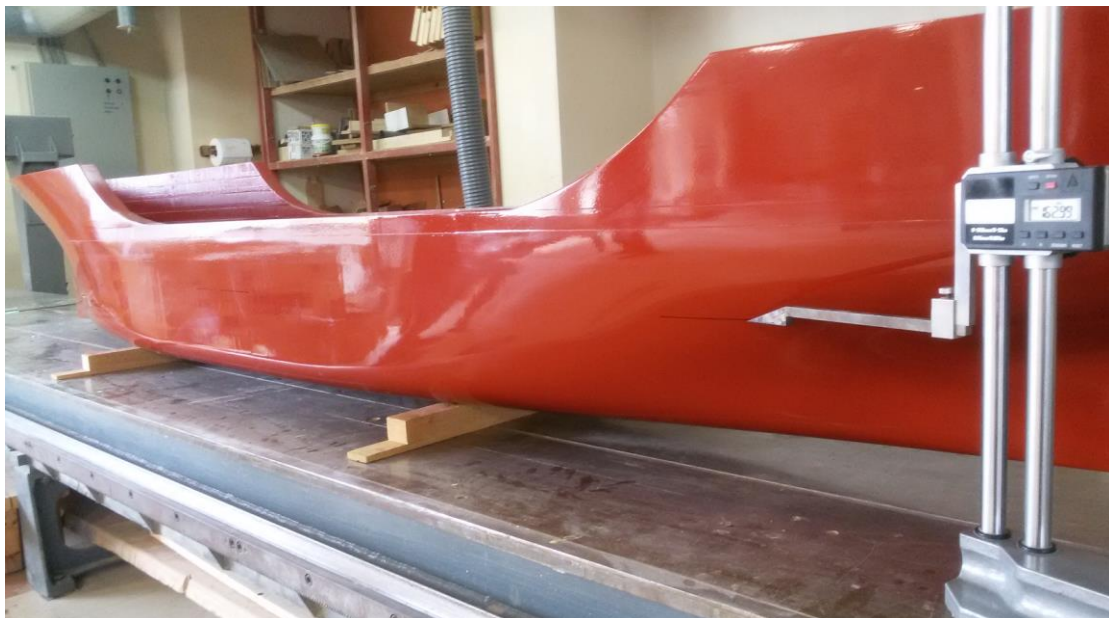
Εικόνα 5-Ισαλοι μοντέλου στο πρυμναίο τμήμα
