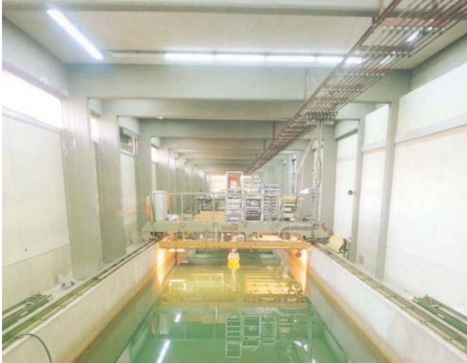
Εικόνα 1 - Πειραματική δεξαμενή ΕΝΘΥ ΕΜΠ
