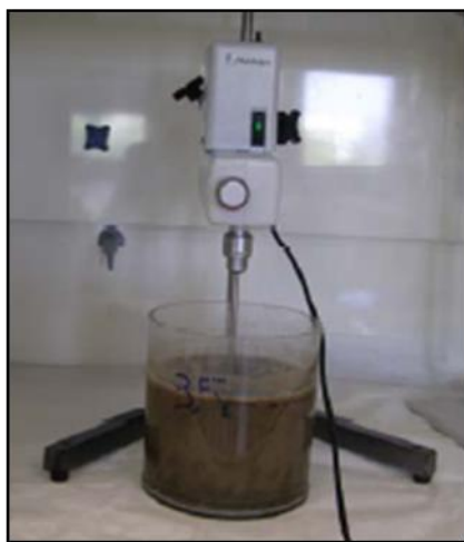
Εικόνα 7.6:Αναδευτήρας τύπου Heidolph R2R 2041 κατά την ανάδευση του λύματος.
