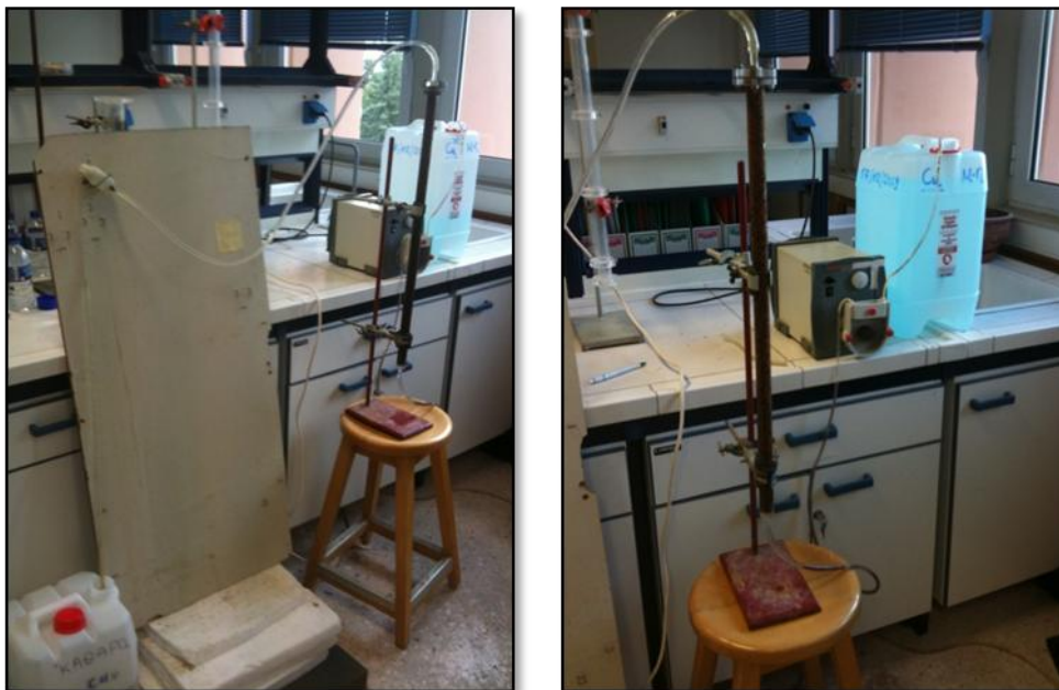
Εικόνα 7.3.: Πειραματική διάταξη στηλών σταθερής ροής με πληρωτικό υλικό “κόμποστ” με πριονίδι.
