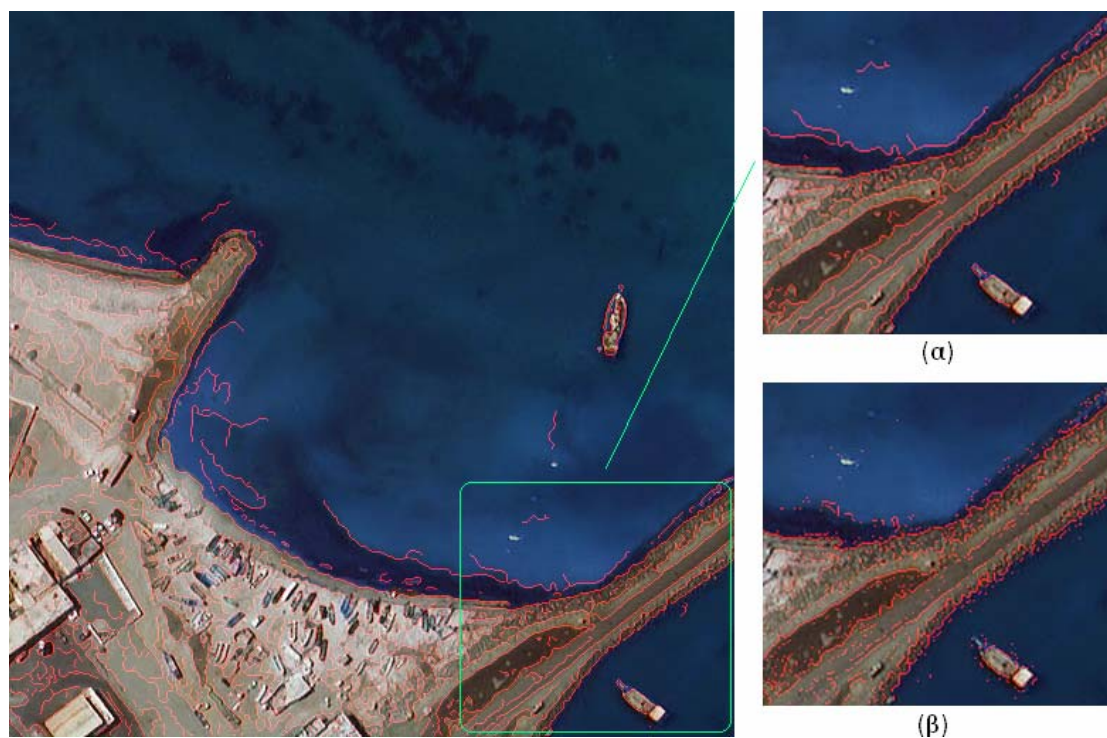
Εικόνα 3.129: 7 η Εφαρμογή, ASF 4 επαναλήψεων. Ανίχνευση ακμών σε τμήμα της αρχικής εικόνας (α) με τον τελεστή Canny, (β) με το μορφολογικό Laplace τελεστή.
