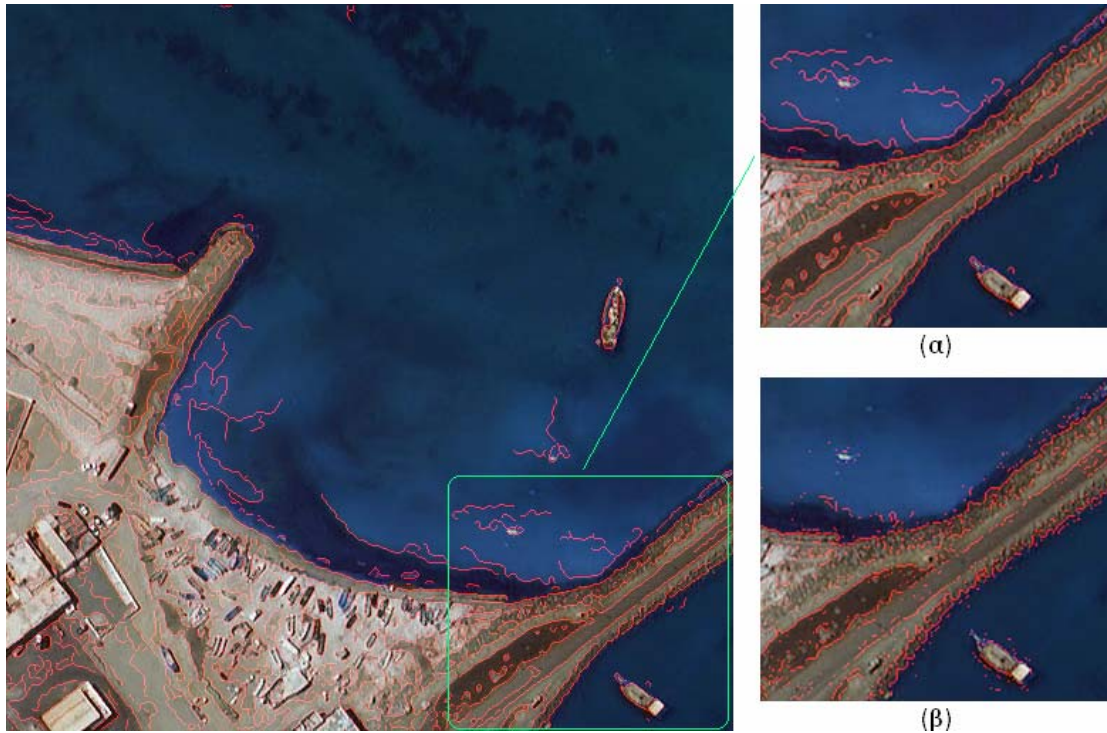
Εικόνα 3.136: 7 η Εφαρμογή, ML 11 επαναλήψεων. Ανίχνευση ακμών σε τμήμα της αρχικής εικόνας (α) με τον τελεστή Canny, (β) με το μορφολογικό Laplace τελεστή.
