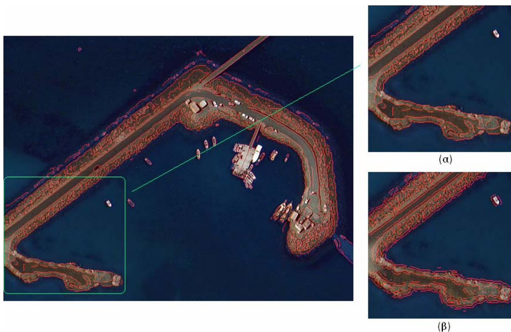
Εικόνα 3.117: 6 η Εφαρμογή, PM 11 επαναλήψεων. Ανίχνευση ακμών σε τμήμα της αρχικής εικόνας (α) με τον τελεστή Canny, (β) με το μορφολογικό Laplace τελεστή.
