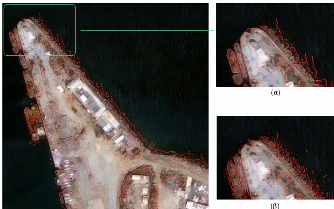
Εικόνα 3.88: 4 η Εφαρμογή, ASF 4 επαναλήψεων. Ανίχνευση ακμών σε τμήμα της αρχικής εικόνας (α) με τον τελεστή Canny, (β) με το μορφολογικό Laplace τελεστή.
