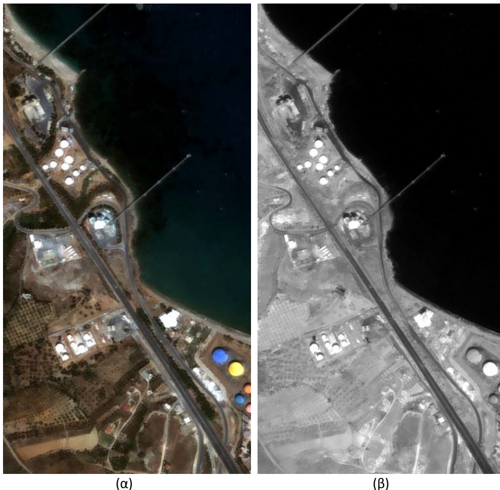
Εικόνα 3.20: (α) Απεικόνιση QUICKBIRD στο φυσικό έγχρωμο σύνθετο, (β) Απεικόνιση QUICKBIRD στο εγγύς υπέρυθρο κανάλι.
