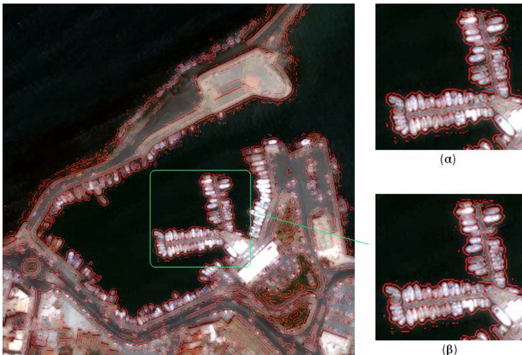
Εικόνα 3.105: 5 η Εφαρμογή, ανιστροπική διάχυση ALM (α) 1 επανάληψης, (β) 200 επαναλήψεων με το μορφολογικό Laplace τελεστή, σε τμήμα της αρχικής εικόνας. Παράδειγμα σύγκλισης του αλγορίθμου.
