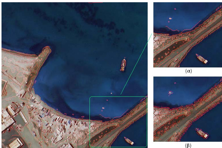
Εικόνα 3.131: 7 η Εφαρμογή, PM 11 επαναλήψεων. Ανίχνευση ακμών σε τμήμα της αρχικής εικόνας (α) με τον τελεστή Canny, (β) με το μορφολογικό Laplace τελεστή.
