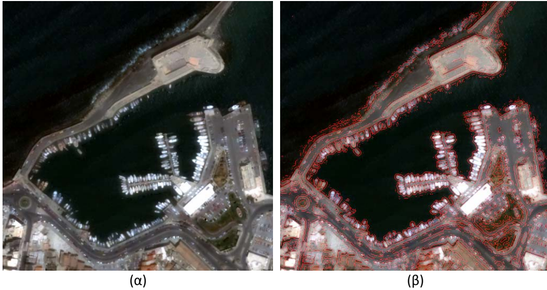
Εικόνα 4.36: 5 η Εφαρμογή, (α) απεικόνιση QUICKBIRD στο φυσικό έγχρωμο σύνθετο, (β) ανισοτροπική διάχυση ALM 200 επαναλήψεων και ανίχνευση ακμών με το μορφολογικό Laplace τελεστή.
