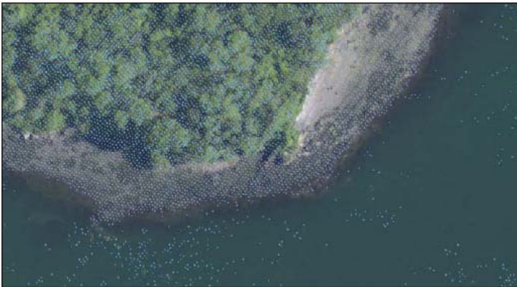
Εικόνα 1.4: Το σύννεφο σημείων LIDAR προβεβλημένο στην ορθοαπεικόνιση (Lee et al., 2009).
