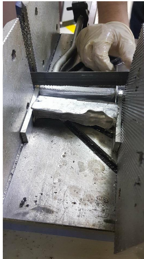
Εικόνα 103 : Η πριονοκορδέλα και ο τρόπος συγκράτησης ορισμένων δοκιμίων με μικρό πάχος
