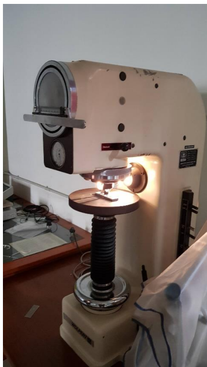
Εικόνα 86 : Η μηχανή μέτρησης σκληρότητας
