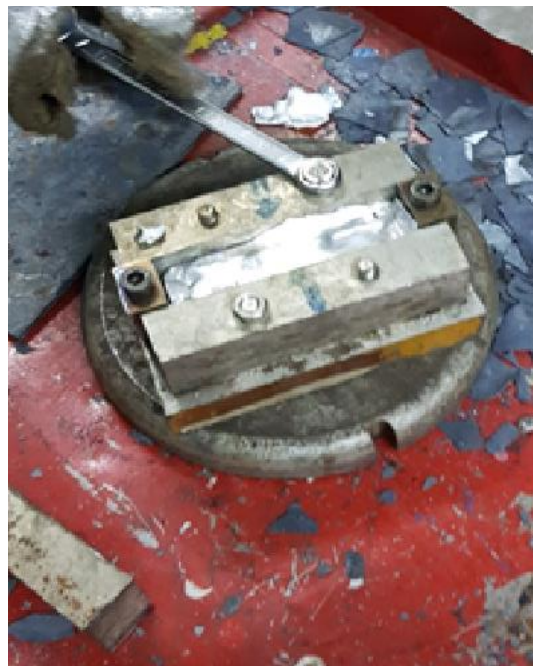
Εικόνα 75 : Αφαίρεση του χυτευμένου τεμαχίου
