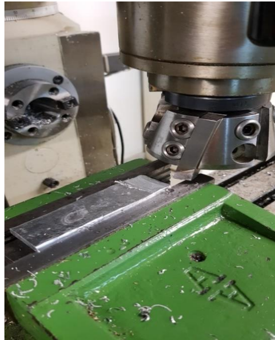
Εικόνα 92 : κοπή τεμαχίων στην φρέζα
