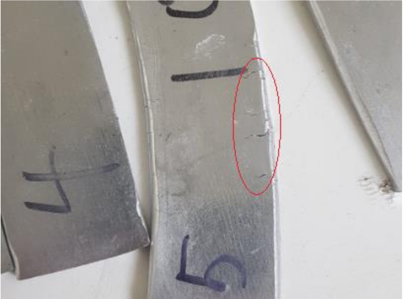
Εικόνα 115 : Ρωγμές σε μερικά από τα δοκίμια αλουμινίου-γραφενίου
