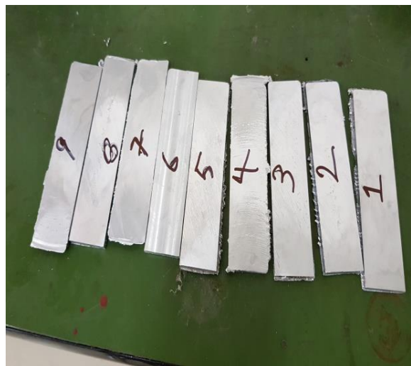
Εικόνα 93 : Ποιότητα επιφάνειας που επιτυγχάνεται με την λείανση (δεξιά). Ποιότητα επιφάνειας πριν (αριστερά)
