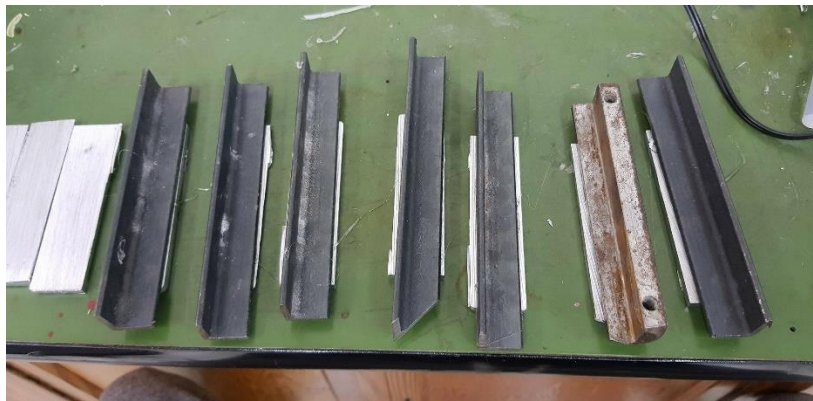
Εικόνα 105 : Αφαίρεση μεγάλου πάχους με λείανση
