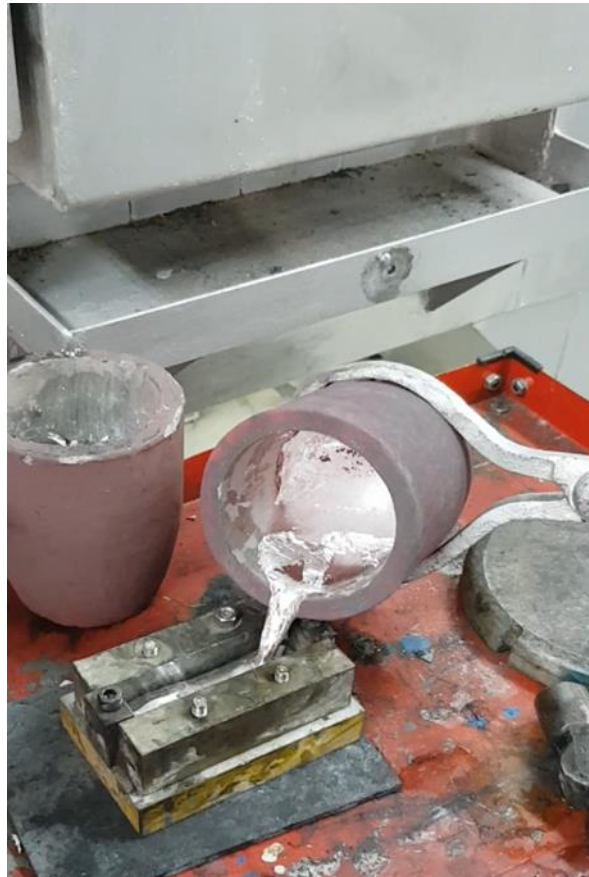
Εικόνα 101 : Χύτευση του τήγματος αλουμινίου-γραφενίου
