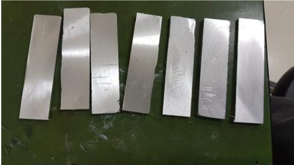
Εικόνα 80 : Λείανση με χαρτί 500
