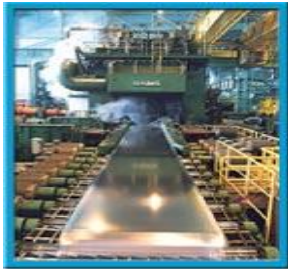
Εικόνα 44 : Θερμή έλαση αλουμινίου
