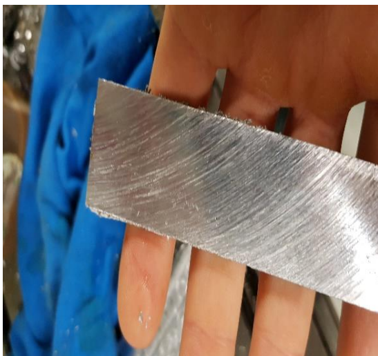
Εικόνα 93 : Ποιότητα επιφάνειας που επιτυγχάνεται με την λείανση (δεξιά). Ποιότητα επιφάνειας πριν (αριστερά)
