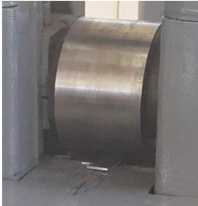
Εικόνα 83 : Εισαγωγή του δοκιμίου στο έλαστρο
