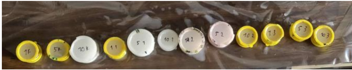
Εικόνα 124 : Τα δοκίμια μετά τον εγκυβωτισμό
