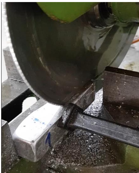
Εικόνα 91 : Κοπή τεμαχίων στον τροχό
