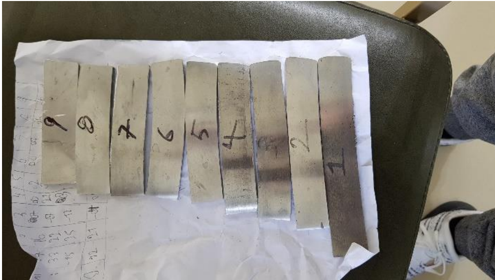
Εικόνα 94 : Μορφή δοκιμίων μετά την έλαση
