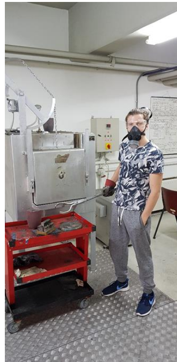
Εικόνα 96 : Μέτρα ασφαλείας κατά την χύτευση
