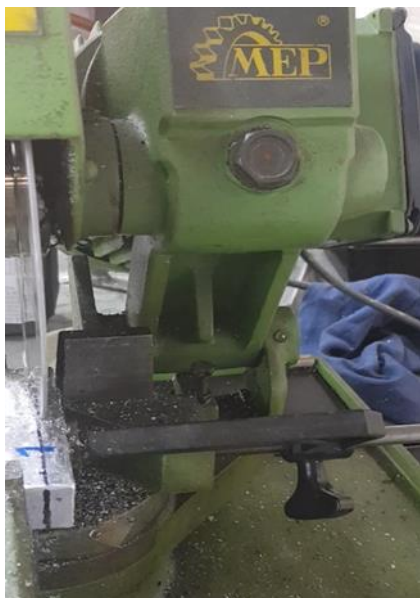
Εικόνα 77 : Κοπή τεμαχίων στον τροχό
