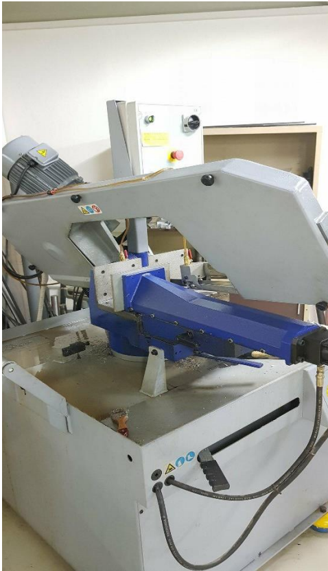
Εικόνα 103 : Η πριονοκορδέλα και ο τρόπος συγκράτησης ορισμένων δοκιμίων με μικρό πάχος
