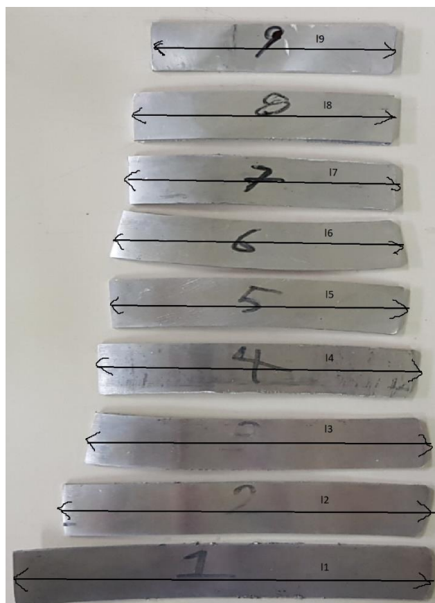
Εικόνα 95 : Μήκη δοκιμίων μετά την έλαση
