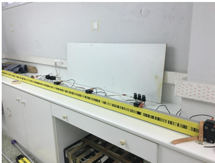
Εικόνα 3.11 Προσαρμογή των αισθητήρων στην τρίμετρη σταδία
