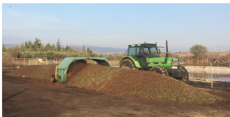
Σχήμα 2.2: Σύστημα δυναμικού αερισμού μέσω αναστροφής
