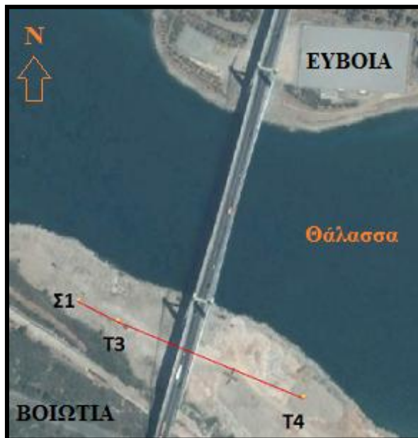
Σχήμα 3.3 Κάτοψη του τοπικού δικτύου που ιδρύθηκε για τις ανάγκες των πειραμάτων
