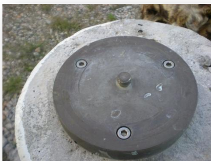
Εικόνα 3.3 Ορειχάλκινη πλακέτα εξαναγκασμένης κέντρωσης πακτωμένη σε βάθρο
