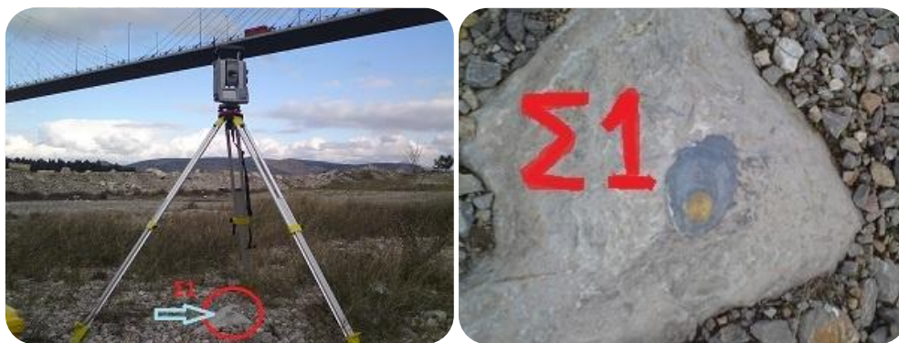
Εικόνα 3.9 Η στάση Σ1 που ιδρύθηκε για τις ανάγκες των πειραμάτων
