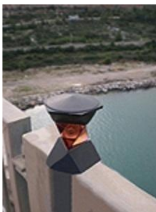
Εικόνα 3.8 Ο αμφιπρισματικός ανακλαστήρας GRZ4 360° της εταιρείας Leica
