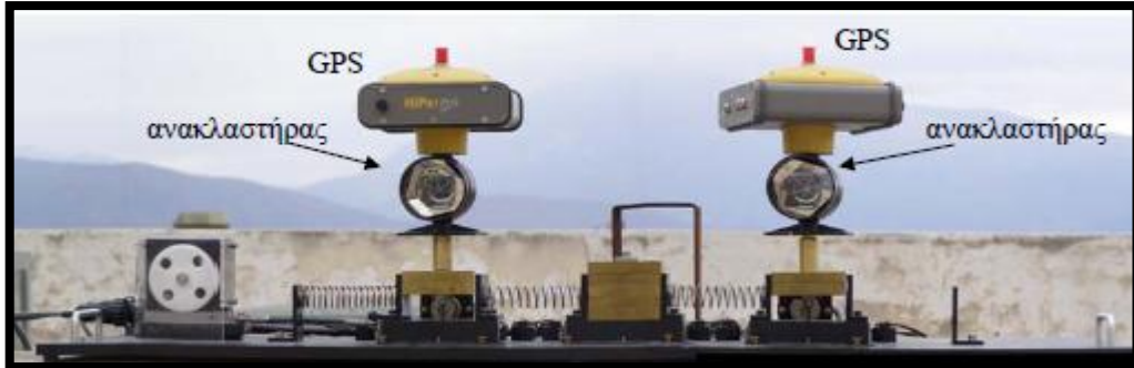
Εικόνα 1.4 Διάταξη τριτοβάθμιου ταλαντωτή
