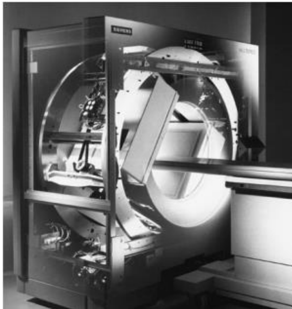
Σχήμα 2.13: Ο αστάλιος σκελετός μηχανήματος SPECT της Siemens. [5]
