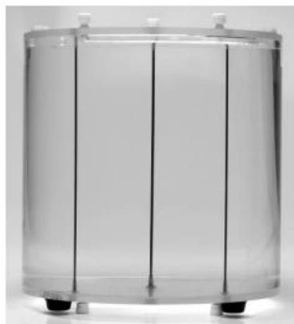
Σχήμα 2.40: Εμπορικό phantom τριπλής σημειακής πηγής γεμισμένο με νερό.
