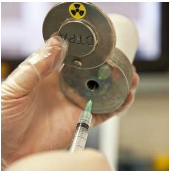
Σχήμα 2.24: Θωρακισμένο φιαλίδιο από μόλυβδο για φύλαξη του ραδιοφαρμάκου. [3]
