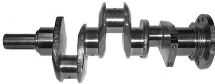
Σχήμα 5.1.6 - Στροφαλοφόρος άτρακτος 3-κύλινδρου κινητήρα εν-σειρά διάταξης.[4]
