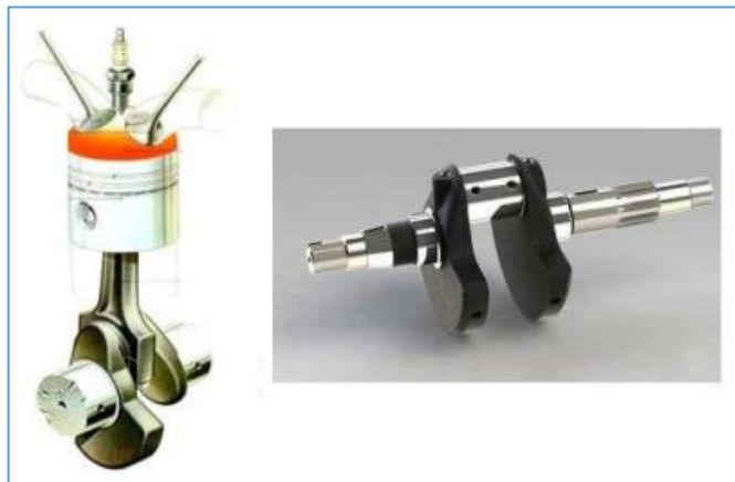
Σχήμα 4.1 - Αντίβαρο στην προέκταση του στροφάλου (αριστερά) και λεπτομέρειά του (δεξιά) για την αντιστάθμιση δυνάμεων από περιστρεφόμενες μάζες μονοκύλινδρου κινητήρα. [3]
