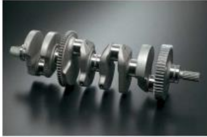
Σχήμα 6.2.1 Στροφαλοφόρος άτρακτος τετρακύλινδρου 4-X κινητήρα εν-σειρά διάταξης με αντίβαρα στην προέκταση των στροφάλων.[4]
