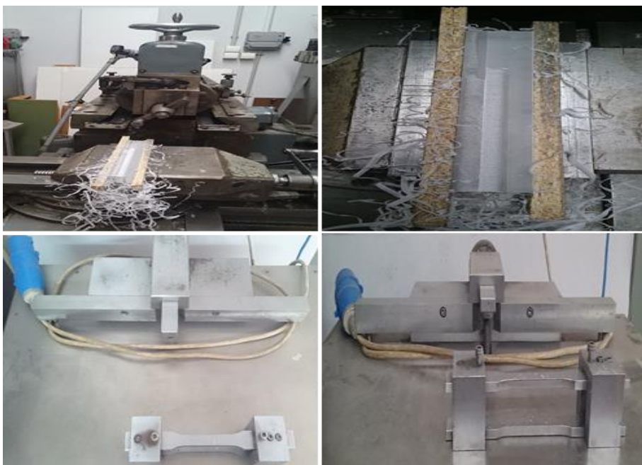
Εικόνα 4.1: Μηχανήματα για την προετοιμασία των δοκιμίων για το πείραμα μονοαξονικού εφελκυσμού σε σχήμα Dog Bone .
