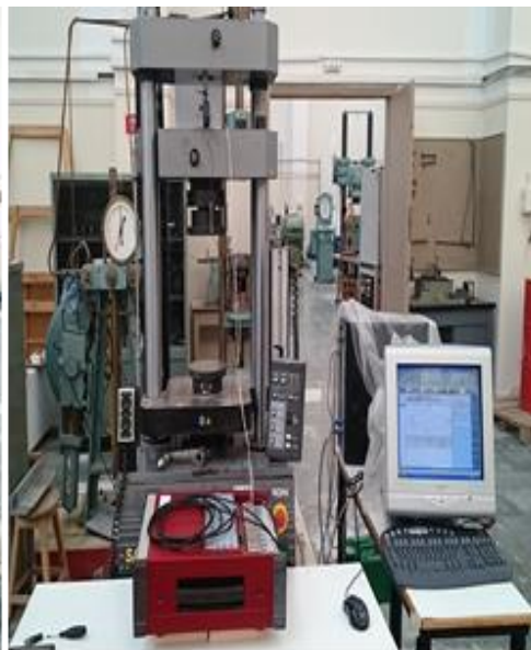
Εικόνα 4.8: (β) Πειραματική διάταξη για το πείραμα μονοαξονικού εφελκυσμού.
