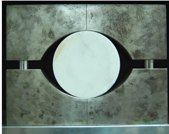
Εικόνα 1.1: Πείραμα Βραζιλιανού δίσκου.
