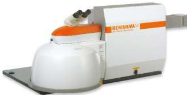
Σχήμα 3.11 Φασματόμετρο Raman , Renishaw Invia-Reflex .
