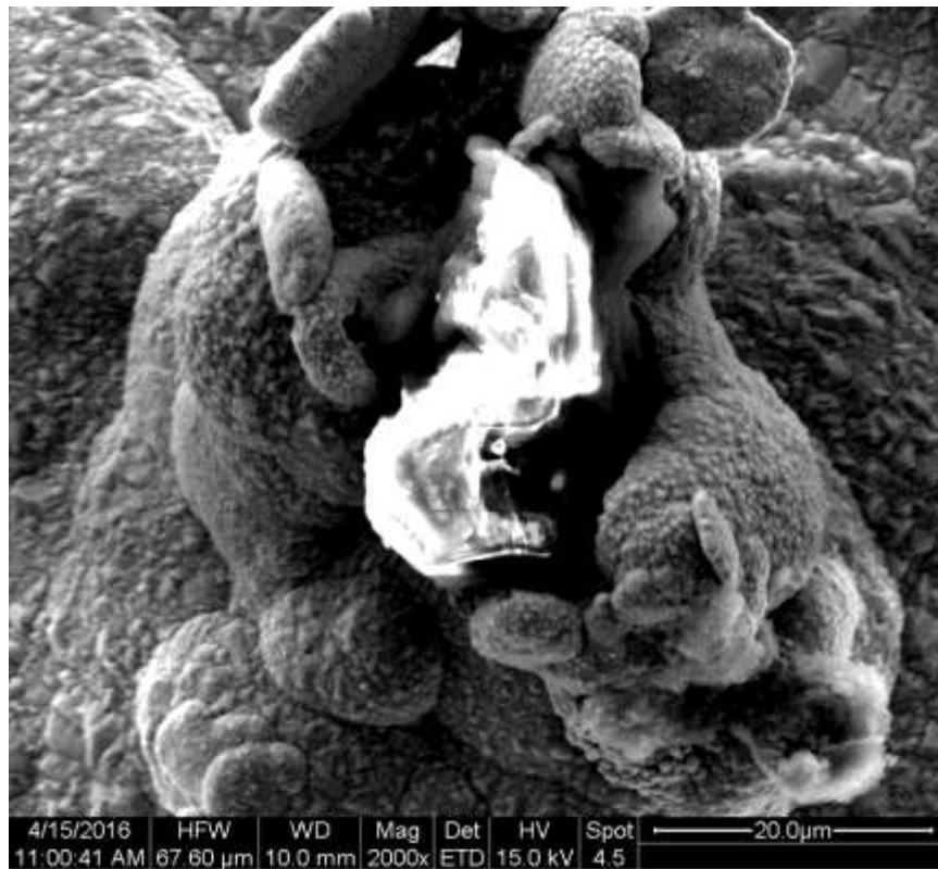
Σχήμα 4.17 Μικροφωτογραφία SEM μεγέθυνσης X2000, σύνθετης επικάλυψης η οποία παρασκευάστηκε σε συνθήκες συνεχούς ρεύματος DC, απουσία οργανικού προσθέτου
