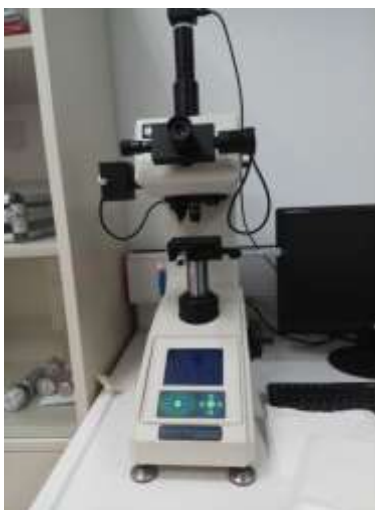
Σχήμα 3.13 Σκληρόμετρο Vickers με συζευγμένο οπτικό μικροσκόπιο.
