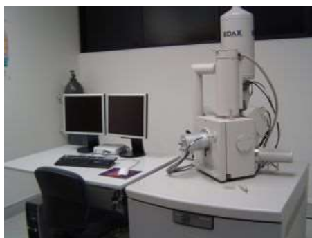
Σχήμα 3.8 Συσκευή SEM και EDX, της εταιρείας FEI, μοντέλο FEI QUANTA 200.
