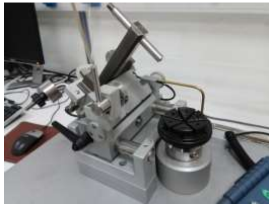
Σχήμα 3.15 Απεικόνιση συσκευής ball-on-disc [7].
