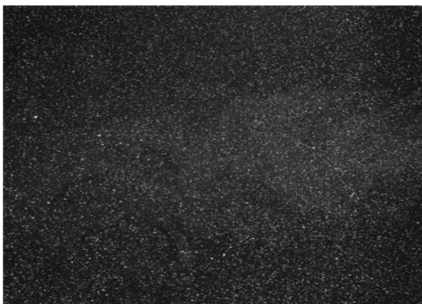
Εικόνα 27. Στιγμιότυπο της ροής όπως αποτυπώνεται με τη μέθοδο του PIV και τα σωματίδια διασκορπισμού.
