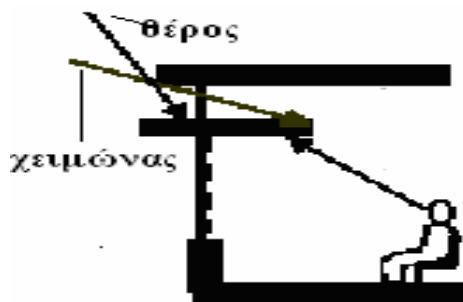
Εικόνα 13: Ράφια φωτισμού (Πηγή: www.energysmartschools.gov )
