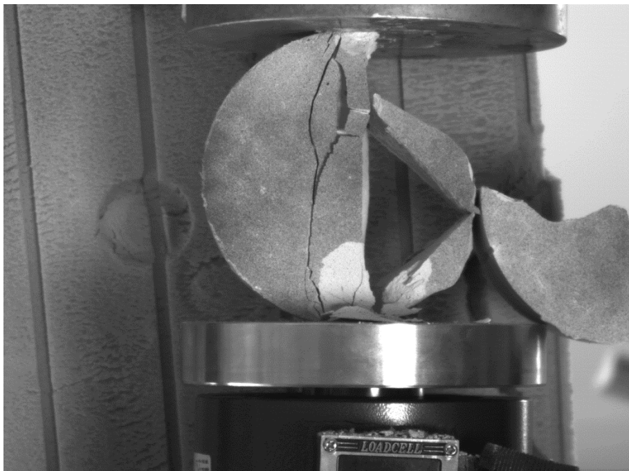
Εικόνα 3.26: Τελική φάση παραμόρφωσης – Πλήρης αστοχία του δοκιμίου
