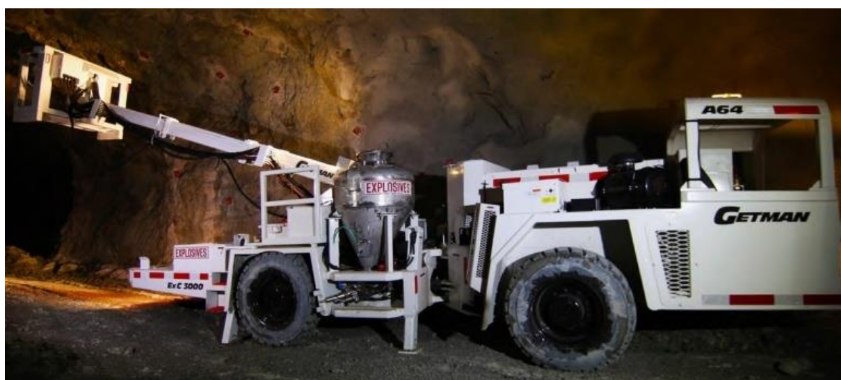
Εικόνα 10.8: Όχημα υπογείων στο οποίο ενσωματώνεται το mup
