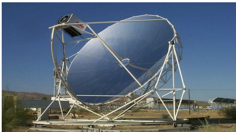
Εικόνα 2.27: Ηλιακό πιάτο με μηχανή Stirling [2.26]
