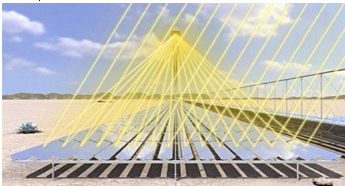
Εικόνα 2.22: Λειτουργία συλλέκτη Fresnel [2.22]
