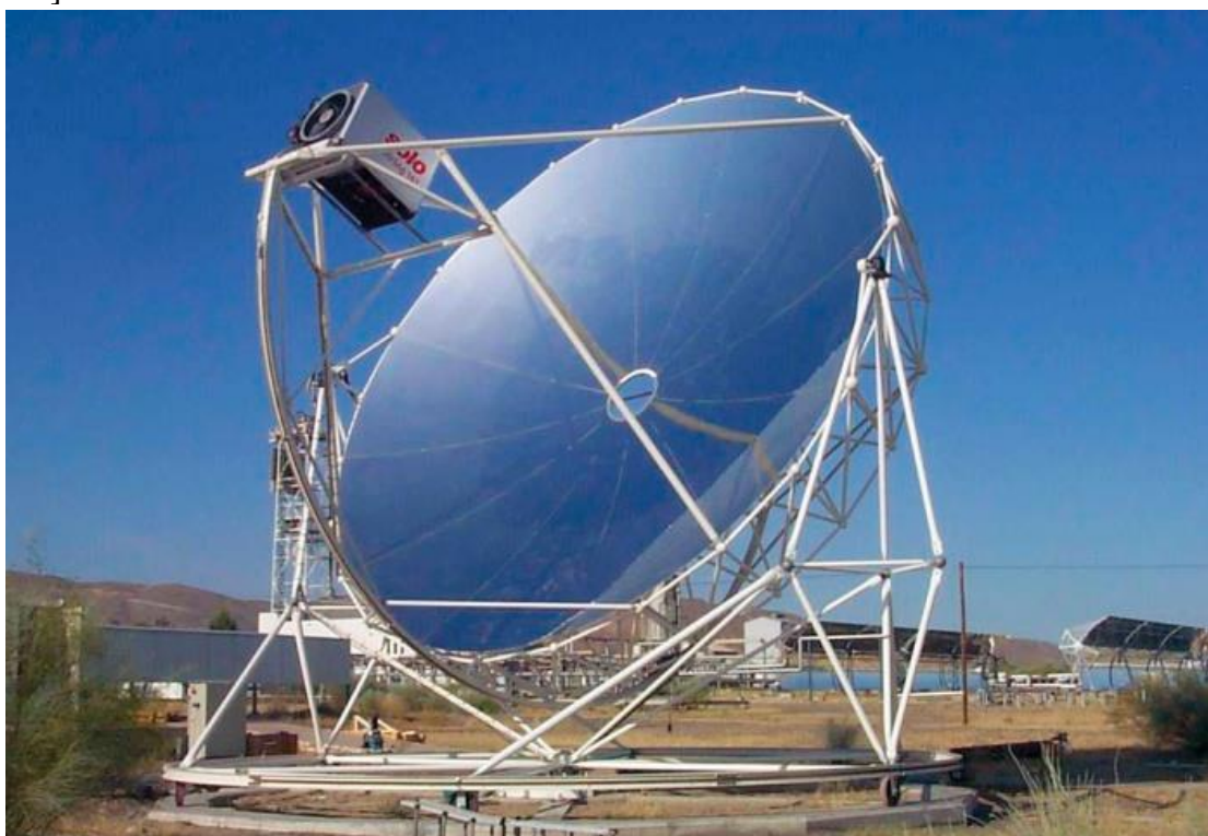
Εικόνα 2.15 Συλλέκτης με παραβολοειδές κάτοπτρο [2.14]
