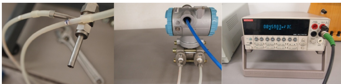
Σχήμα 3. 7 α) Κατάληξη σωλήνα Prandtl εκτός ροής, β) Μανόμετρο για μέτρηση διαφοράς ολικής-στατικής πίεσης, γ) Πολύμετρο
