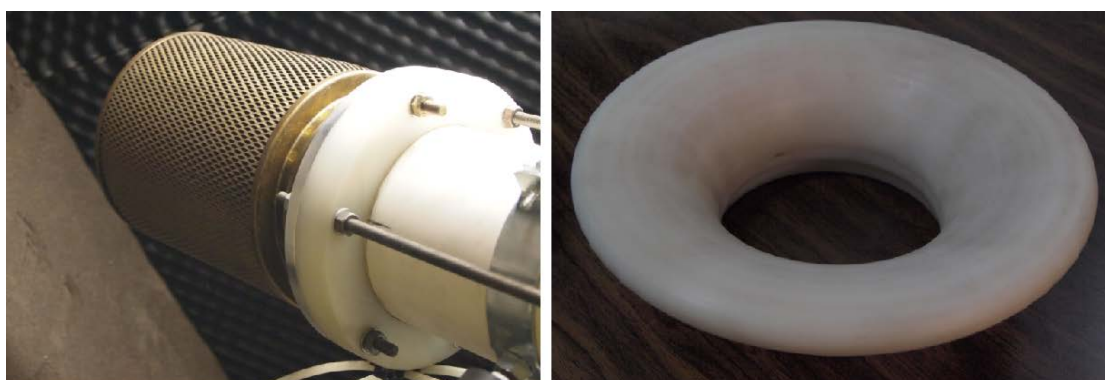
Σχήμα 4. 7 α) Φίλτρο αέρα εισαγωγής Η/Ζ, β) Bellmouth
