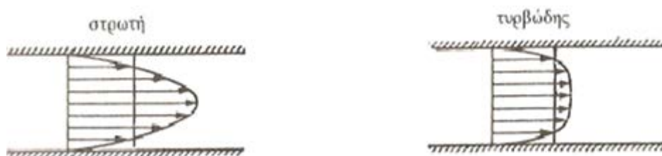
Σχήμα Α. 5 Κατανομή της ταχύτητας σε σωλήνα (στρωτή και τυρβώδης ροή) [13]
