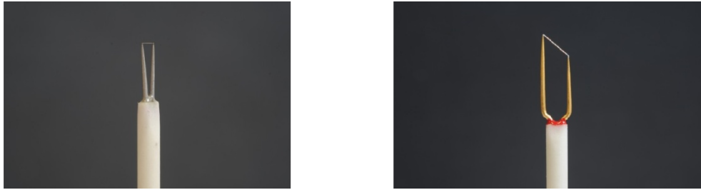
Σχήμα 3. 3 Θερμό νήμα (αριστερά) και θερμό φιλμ (δεξιά)
