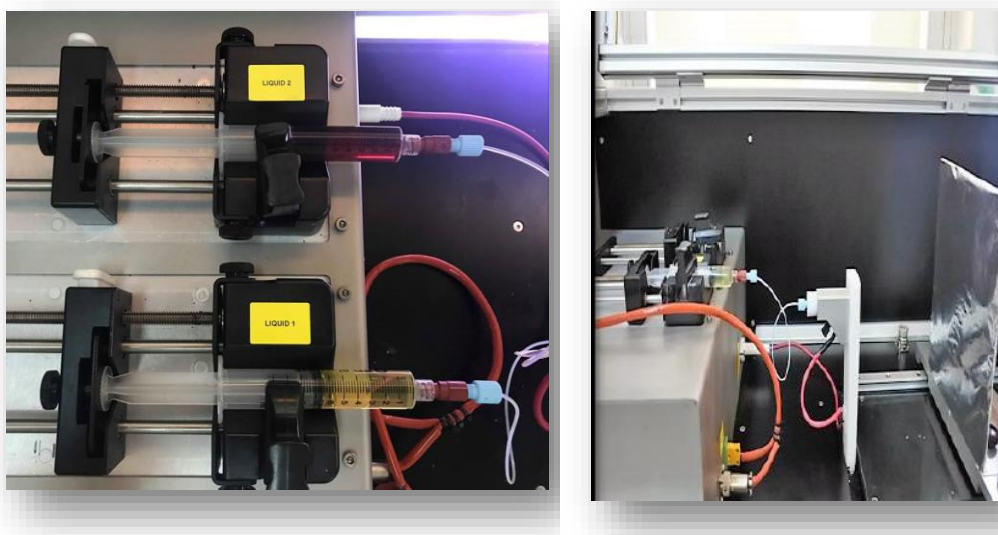
Εικόνα 32: Διάταξη ηλεκτροστατικής ινοποίησης-Εγκλεισμός σε μήτρα β-κυκλοδεξτρίνης
