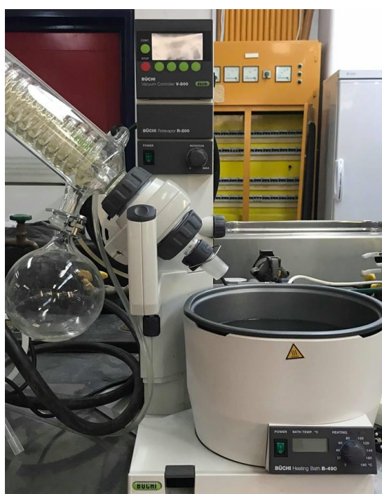
Εικόνα 25: Περιστροφικός εξατμιστήρας Rotavapor της Buchi του εργαστηρίου ΣΑΔ
