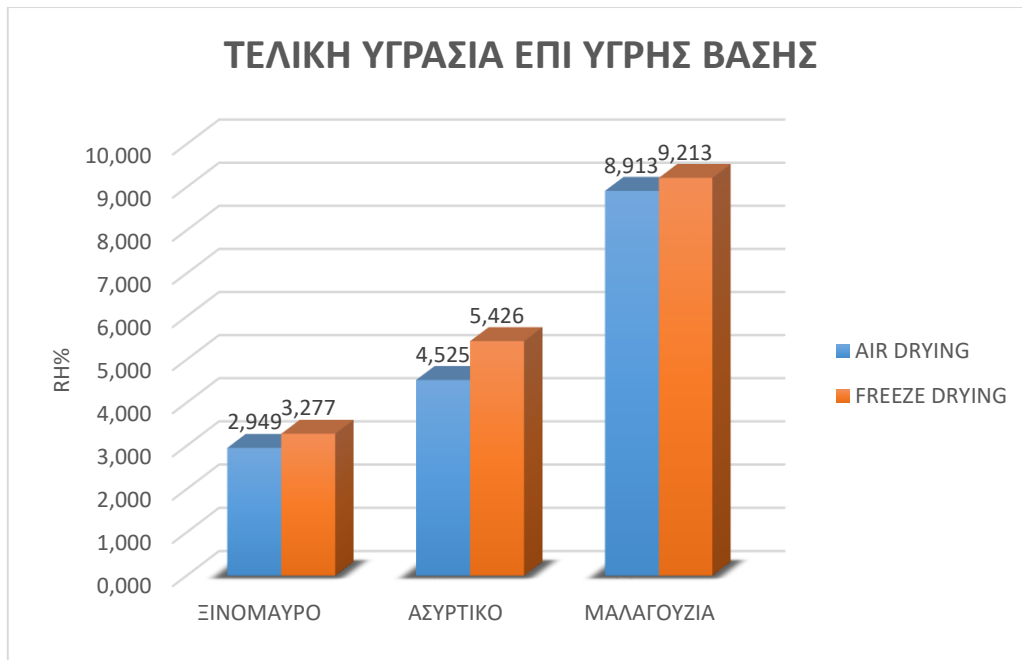
Διάγραμμα 38: Τελική υγρασία δειγμάτων επί υγρής βάσης όπως προσδιορίστηκε με τις δύο μεθόδους ξήρανσης
