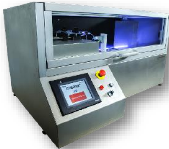
Εικόνα 30: Συσκευή ηλεκτροστατικής ινοποίησης FLUIDNATEK LE – 10,
