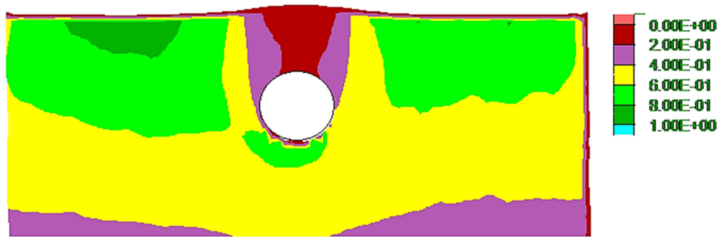
Σχήμα 4.4: Ισοκαμπύλες του λόγου υπερπιέσεων πόρων r_u της αριθμητικής ανάλυσης αναφοράς για υπόγειο αγωγό σε ρευστοποιήσιμο έδαφος στο τέλος της διέγερσης
