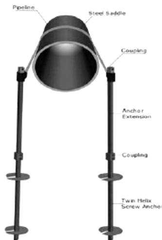
Σχήμα 2.6: Χρήση αγκυρίου για αντιμετώπιση ανύψωσης αγωγού
