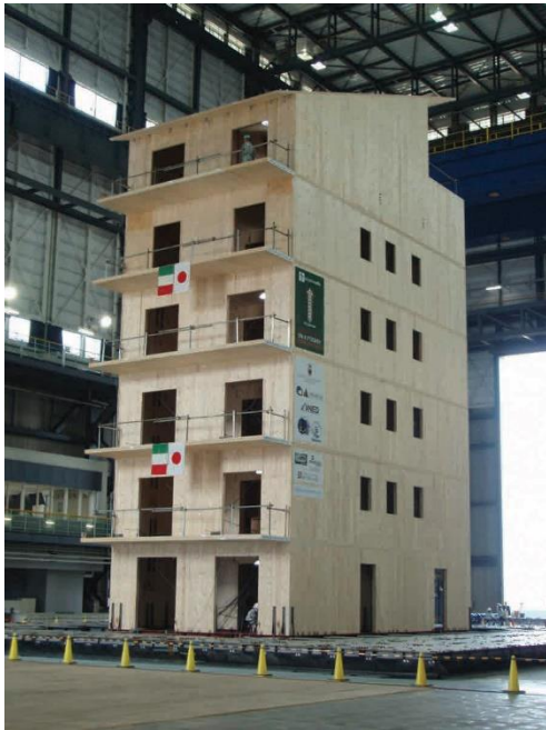
Εικόνα 2.13: Κτίριο επτά ορόφων από CLT σε σεισμική τράπεζα. [Ceccotti et al., 2013]
