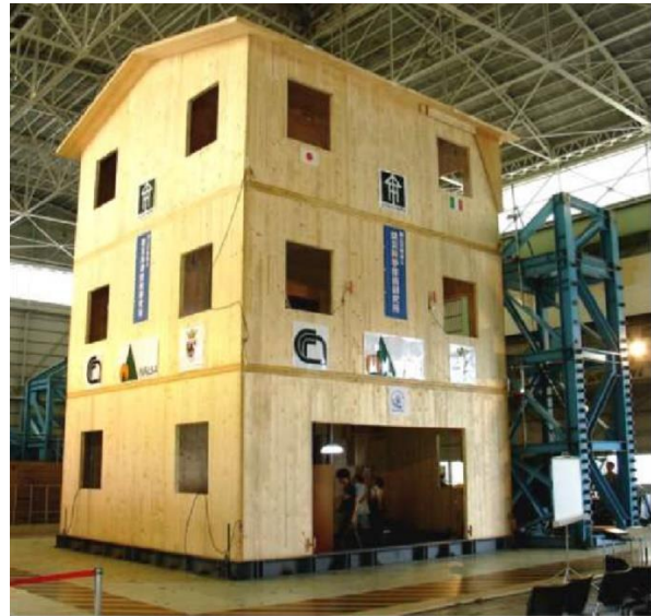
Εικόνα 2.14: Κτίριο τριών ορόφων από CLT σε σεισμική τράπεζα. [Ceccotti et al., 2013]
