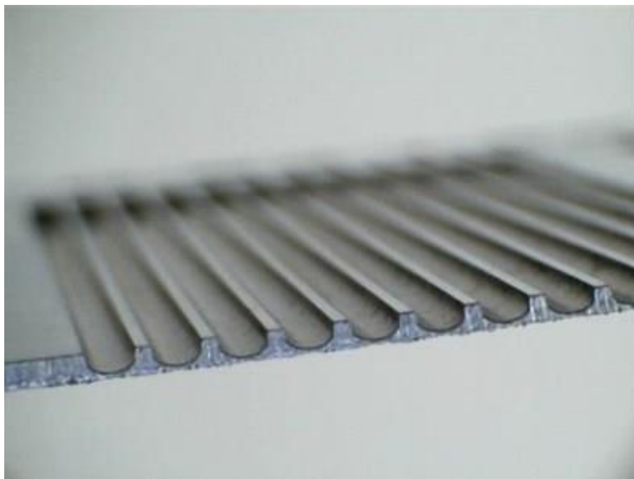
Εικόνα 3.7: Επιφάνεια μετά τη διαδικασία φωτοχημικής χάραξης. [17]
