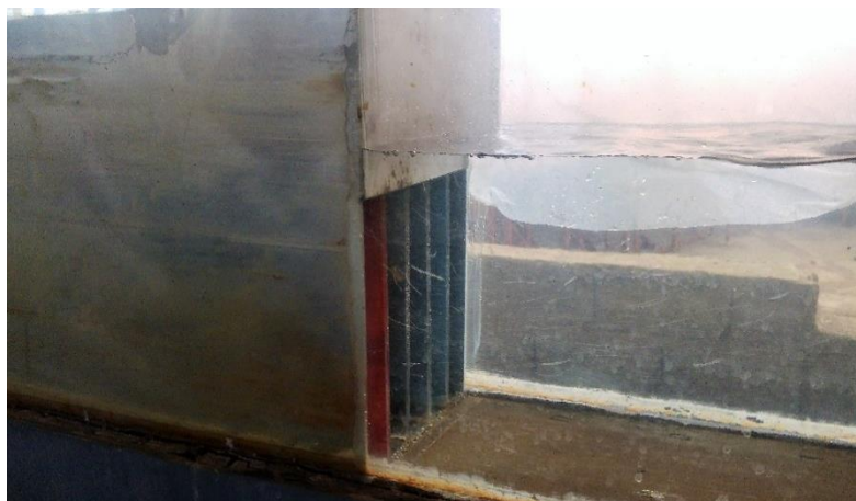
Σχήμα 4.2 (α) Ανάντη άκρο διώρυγας με διάταξη για τη μείωση των αναταράξεων (β) Λεπτομέρεια διάταξης (γ) Λεπτομέρεια διάταξης
