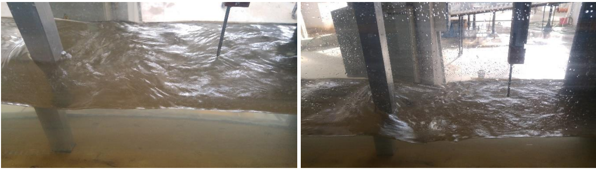
Σχήμα Π1.18 Ροή γύρω από βάθρο τετραγωνικής διατομής
