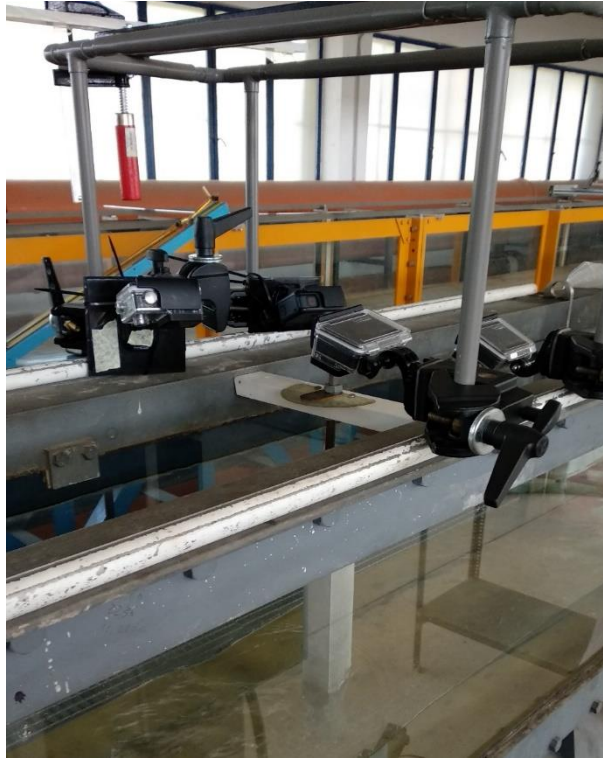
Σχήμα 6.2 Τοποθέτηση των φωτομηχανών πάνω από τη διώρυγα
