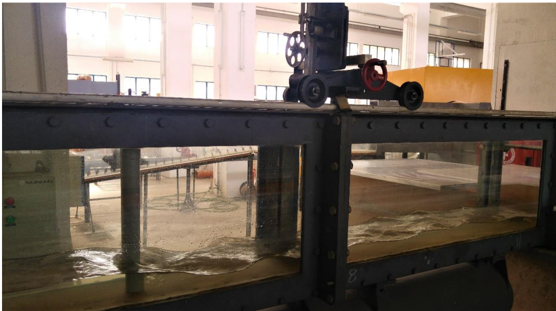
Σχήμα 5.12 Αναταραχή της ροής στα κατόντη για ύψος υπερχείλισης ίσο με w=0 cm, όπου εμφανίζεται υπερκρίσιμη ροή (στην εικόνα φαίνεται η κυλινδρική διατομή, αλλά η αναταραχή εμφανίζεται σε όλες τις διατομές).
