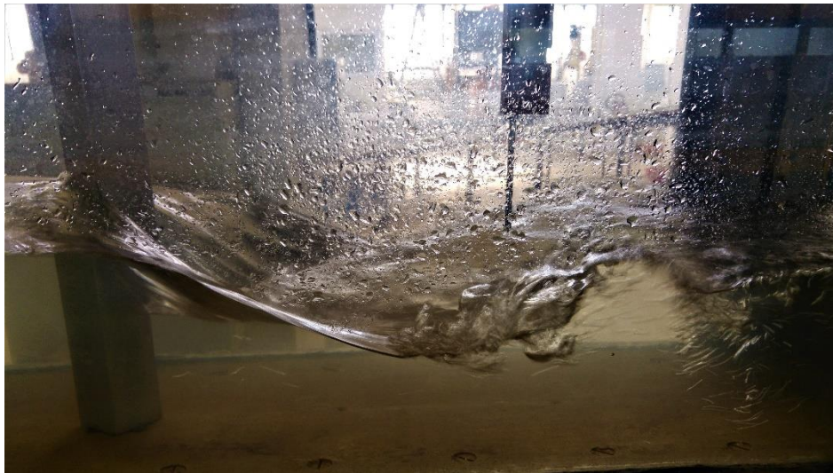
Σχήμα 4.13 Διαταραχή στη θέση μέτρησης x=30 cm σε ροή γύρω από ρομβοειδή διατομή ( Q=25 L/s, w=3 cm)
