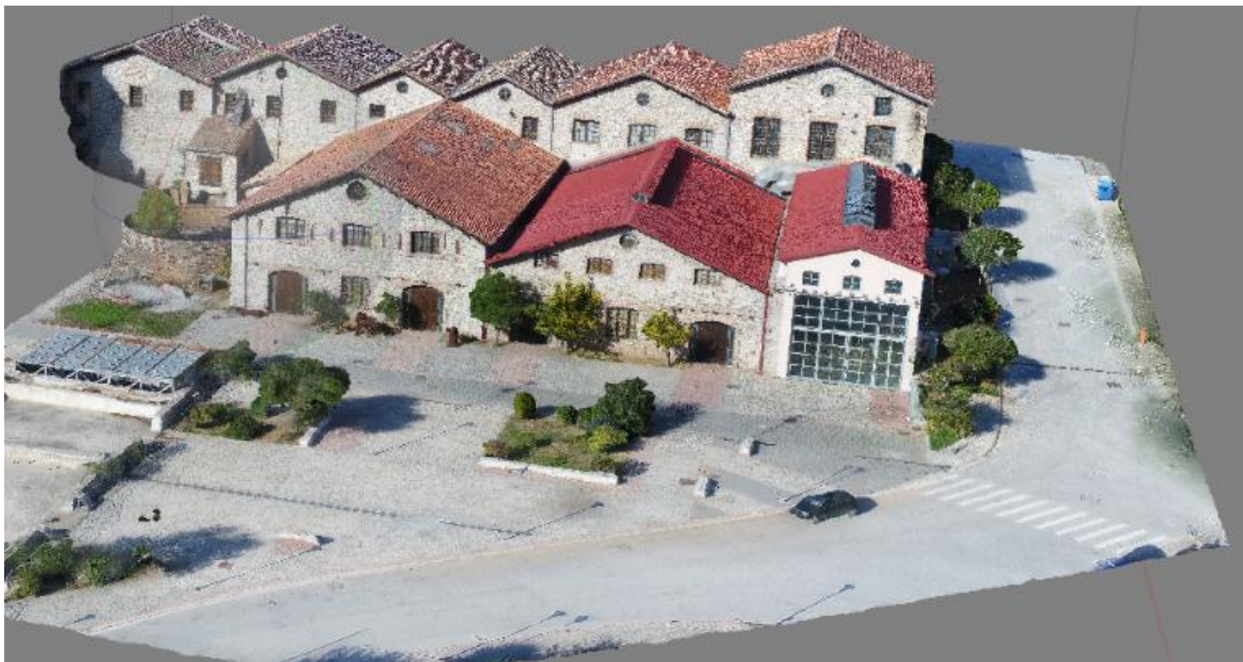
Εικόνα 3.21: Τριδιάστατο μοντέλο με την χρήση UAV
