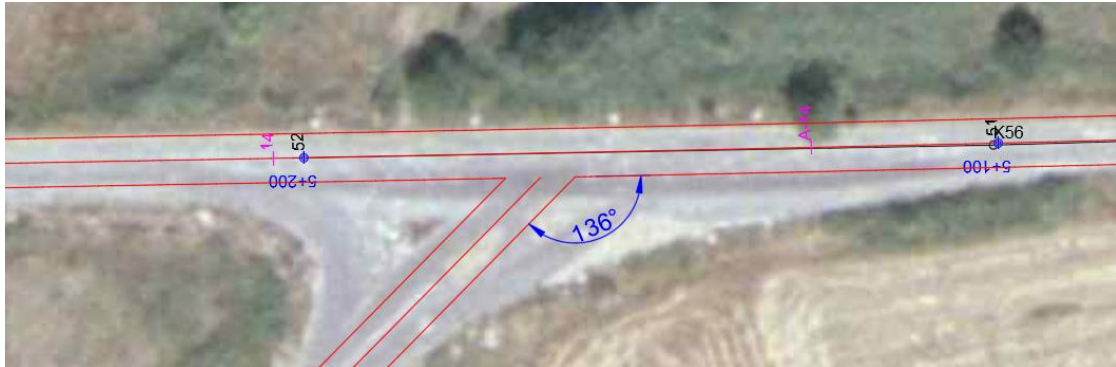
Σχήμα 5.1: Γωνία συμβολής εξεταζόμενου ισόπεδου κόμβου.
