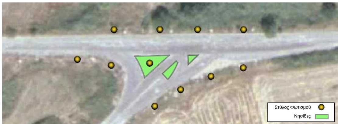
Σχήμα 5.5: Υπάρχων φωτισμός στον εξεταζόμενο ισόπεδο κόμβο.
