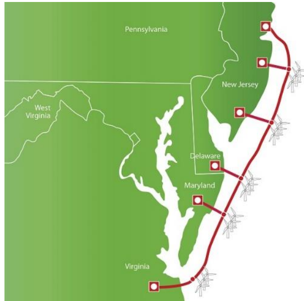
Σχήμα 1.13. VSC MTDC Atlantic Wind Connection (AWC) project στις Η.Π.Α .
