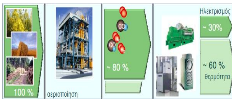
Σχήμα 2.6: Παραγωγή αερίου με αεριοποίηση [28]
