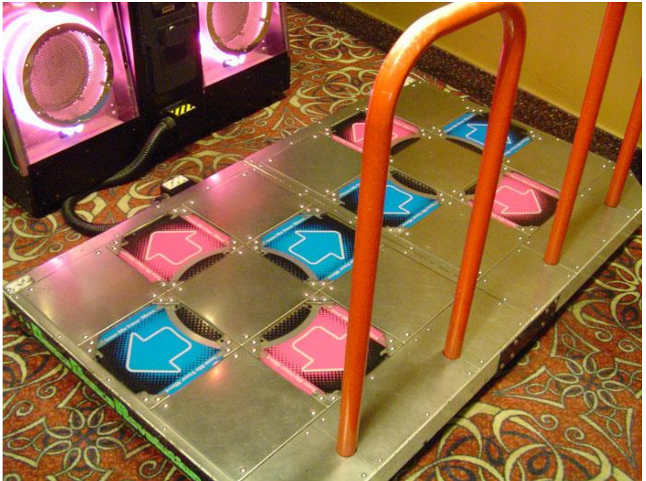
Εικόνα 1. Η πλατφόρμα με τους αισθητήρες πίεσης του DDR 4
