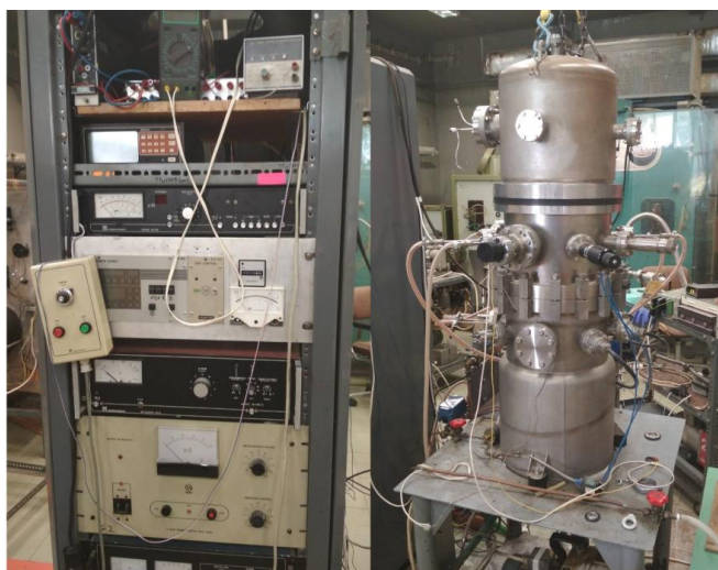
Εικόνα 5.8 Η διάταξη του συστήματος εξάχνωσης με δέσμη ηλεκτρονίων του εργαστηρίου «Εργαστήριο Ηλεκτρονικής Μικροσκοπίας» του ΕΚΕΦΕ "Δημόκριτος".
