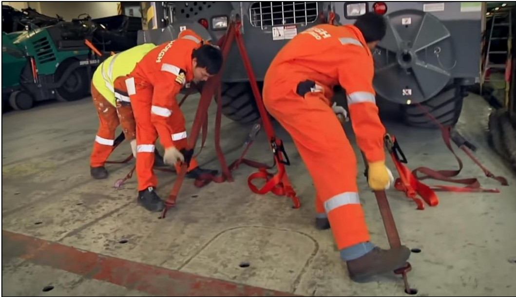
Εικόνα 6: Ασφάλιση οχήματος βαρέος τύπου με ιμάντες (Πηγή: https://www.youtube.com/watch?v=V3mY30VavX0 )
