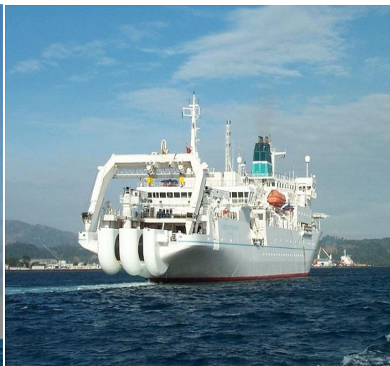
Εικόνα 14: Πλοίο τοποθέτησης καλωδίων
