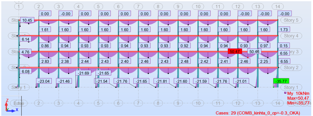
Σχήμα 5.3: Διάγραμμα δυσμενέστερου συνδυασμού καμπτικών ροπών στη διεύθυνση Y
