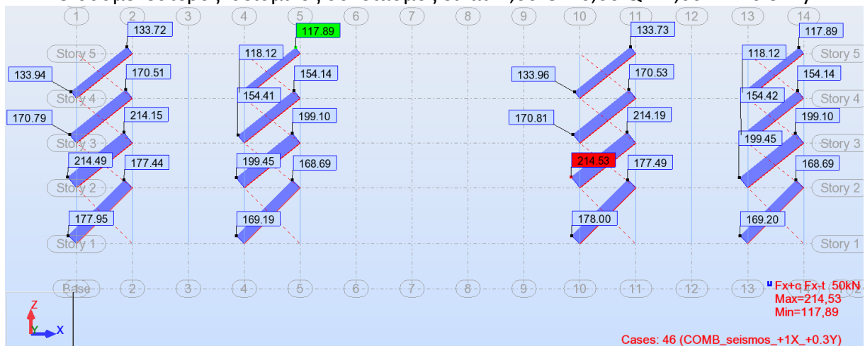
Σχήμα 5.13: Διάγραμμα αξονικών δυνάμεων λόγω σεισμού κατά τη διεύθυνση X
