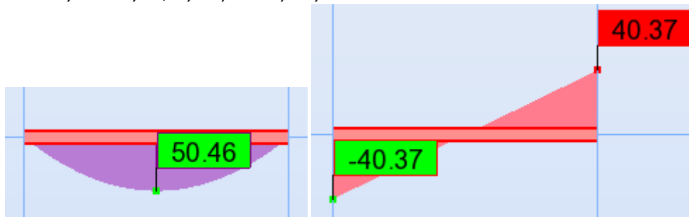
Σχήμα 5.9: Ενδεικτικά διαγράμματα εντακτικών μεγεθών δυσμενέστερης δοκού, M_y , V_z , ( N=0 )
