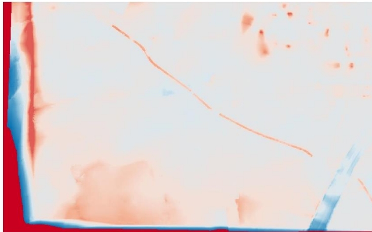
Εικόνα 27: Ανάδειξη χονδροειδών σφαλμάτων και χρωματική απόδοση υψομετρικών διαφορών νότιου τμήματος περιοχής μελέτης σύμφωνα με τα στατιστικά μεγέθη μετά την αφαίρεση των χονδροειδών σφαλμάτων
