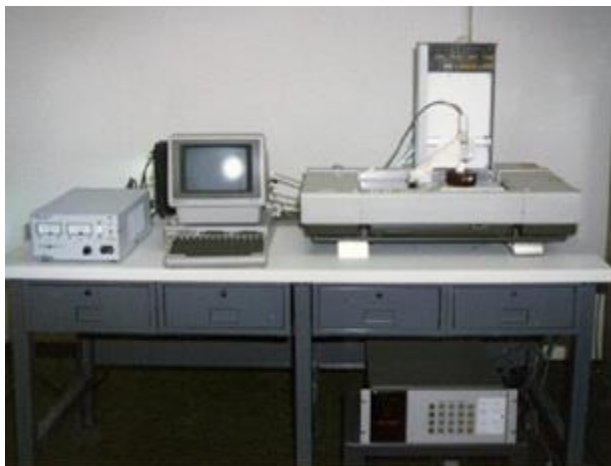
Εικόνα 72 SLA-1, η πρώτη διάταξη Rapid Prototyping, που δημιουργήθηκε το 1983
