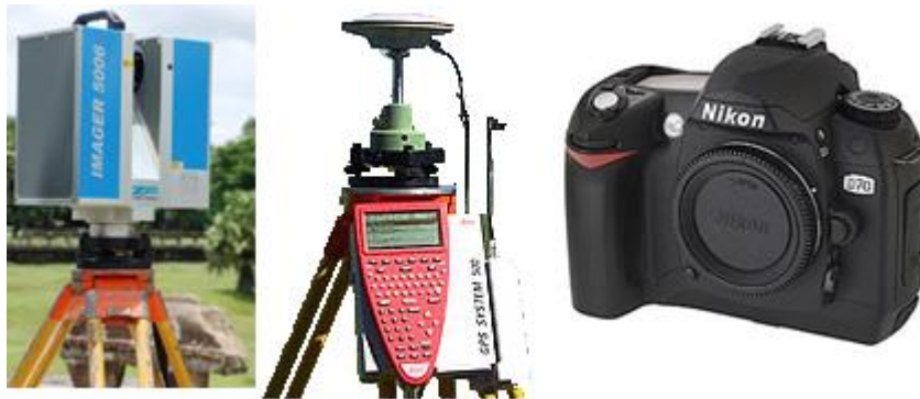
Εικόνα 40 Ο σαρωτής IMAGER 5006, Z+F, το σύστημα GPS 500, Leica, και η φωτογραφική μηχανή Nikon D70
