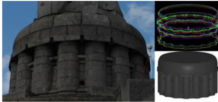
Εικόνα 39 Κομμάτι του κοιλώματος του αγάλματος (αριστερά), διατομές του γεωμετρικού αντικειμένου (δεξιά πάνω), και μοντέλο CAD του κοιλώματος (δεξιά πάνω)
