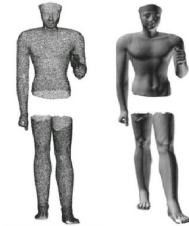
Εικόνα 37 Αριστερά το νέφος σημείων από το σαρωτή Laser, δεξιά μια όψη του μοντέλου
