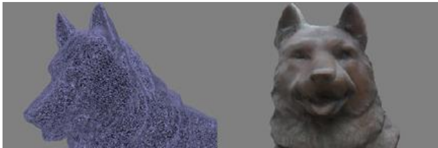
Εικόνα 34 3D πλέγμα και υφή από το Photoscan
