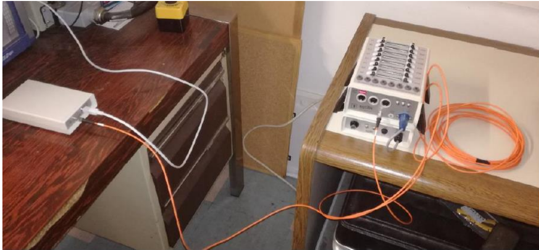
Σχήμα 3.3 : Βλέπουμε τη σύνδεση των μερών του συστήματος μεταξύ τους. Το λευκό USB καλώδιο στα αριστερά συνδέει τον Receiver με τον υπολογιστή.
