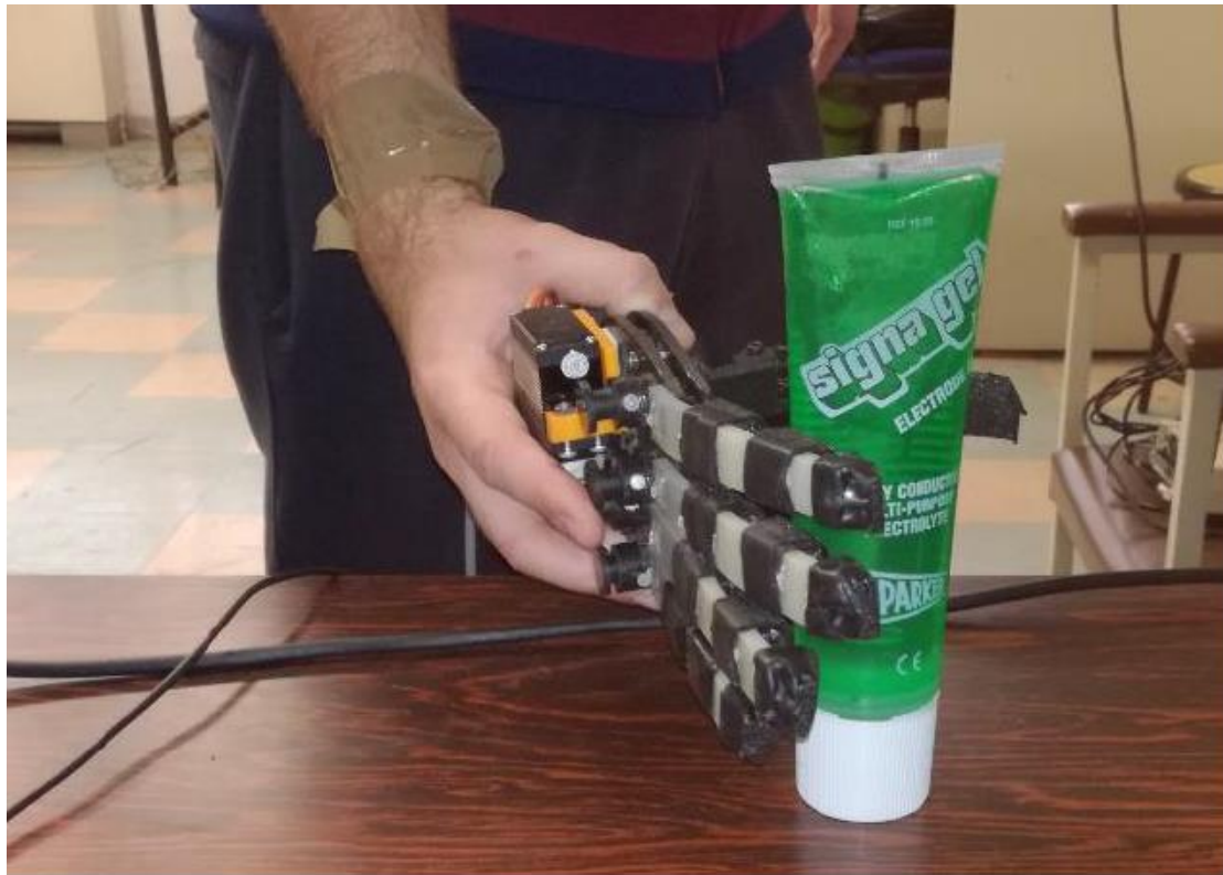
Σχήμα 3.12 : Το προσθετικό χέρι κατά τη διάρκεια των πειραμάτων, στη φάση αρπαγής μπροστά από τον επιθυμητό στόχο. Μελλοντικά το χέρι αυτό τοποθετημένο σε ρομπότ, θα υφίσταται τηλεχειρισμό από το χρήστη μέσω EEG σημάτων και της ανάλυσής τους κατά τη χειρονομία αρπαγής που πραγματεύεται η παρούσα μελέτη.
