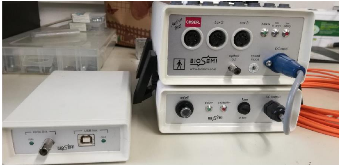
Σχήμα 3.2 : Πρόοψη του μετατροπέα Biosemi και της μπαταρίας από κάτω του. Στα αριστερά ο Receiver.
