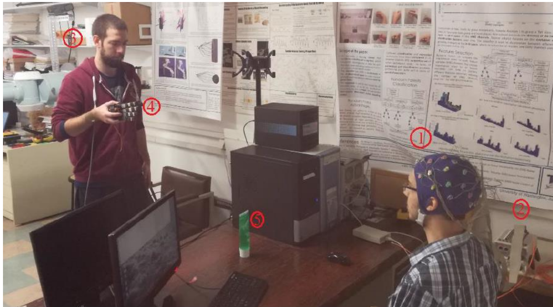
Σχήμα 3.7 : Εκκίνηση του πειράματος. Ο χρήστης (1) έχει φορέσει το σκουφάκι που είναι τοποθετημένα τα ηλεκτρόδια, συνδεδεμένα με τον εξοπλισμό (2) και βρίσκεται σε κατάσταση χαλάρωσης. Ο βοηθός (3) βρίσκεται σε αρχική θέση και ξεκινά να μετακινεί το προσθετικό χέρι (4) έτσι ώστε να φτάσει μπροστά στο αντικείμενο που θέλουμε να αρπάξουμε (5). Ο χρήστης παρατηρεί την κίνηση του χεριού όπως θα έκανε αν το έβλεπε σε περιβάλλον εικονικής πραγματικότητας.
