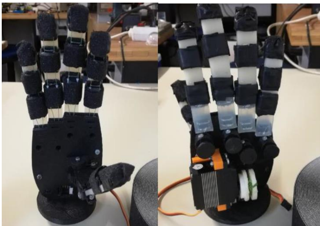
Σχήμα 3.10 : Στην αριστερή εικόνα βλέπουμε την εσωτερική παλάμη του δεξιού προσθετικού χεριού. Στη δεξιά εικόνα είναι το εξωτερικό μέρος, μαζί με τα στρογγυλά κουμπιά του επιλεκτικού μηχανισμού και τον κινητήρα με την τροχαλία.
