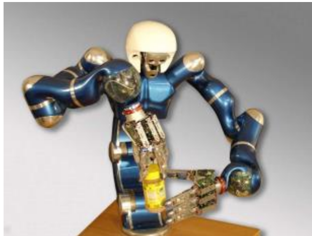
Σχήμα 1.3 : Ανθρωπομορφικό ρομπότ με δύο χέρια βασισμένο στα DLR-LightweightRobot-III και DLRHand-II.
