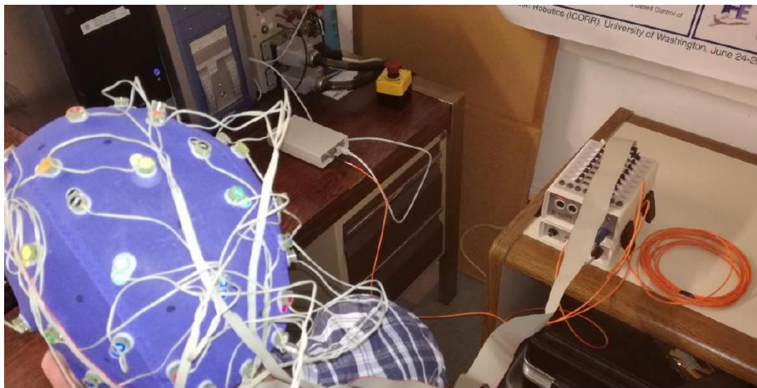
Σχήμα 3.6 : Το σύστημα είναι έτοιμο για την καταγραφή των σημάτων. Ο χρήστης έχει τοποθετήσει το σκουφάκι με τα ηλεκτρόδια που συνδέεται στις θύρες του μετατροπέα AD και στη συνέχεια με τον υπολογιστή.
