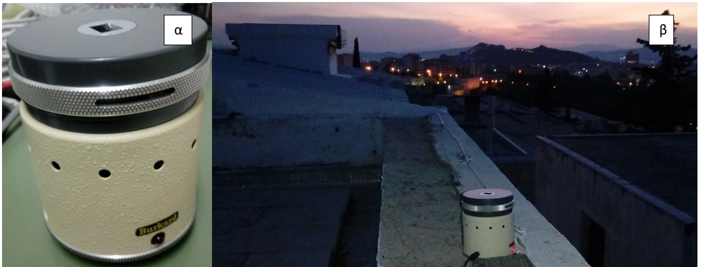
ΣΧΗΜΑ 4.6.5: (α) Απεικονίζεται η παγίδα βιοαερολυμάτων και φαίνονται οι περιφερειακές τρύπες εκροής αέρα, η σχισμή του επιστρεφόμενου δακτυλίου και η σχισμή επάνω από το θάλαμο της πλάκας. (β) Νυχτερινή λειτουργία της παγίδας και πιο μπροστά βρίσκεται το παράθυρο της οροφής του LRSU, απ'όπου και εξέρχεται η δέσμη laser.
