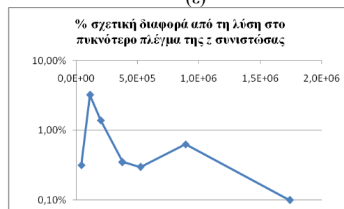
Σχήμα 3.10: Διαγράμματα ταχύτητας και απόκλισης της ταχύτητας στο σημείο τομής των γραμμών, με συντεταγμένες (L/3, w/2, 0.000045-d) , για διαφορετική πυκνωση του πλέγματος, όταν ο αριθμός Re=10 . α) Γραφική απεικόνιση του σημείου. β) Προφίλ της x συνιστώσας της ταχύτητας. γ) % σχετική
