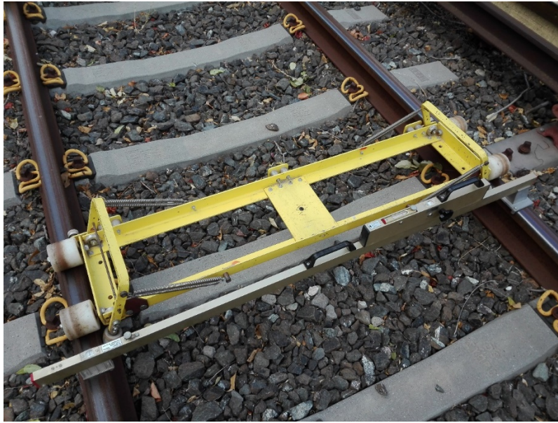
Εικόνα 4.13: Συμβατικό τρόλεϋ και όργανα μέτρησης εύρους και υπερύψωσης γραμμής
