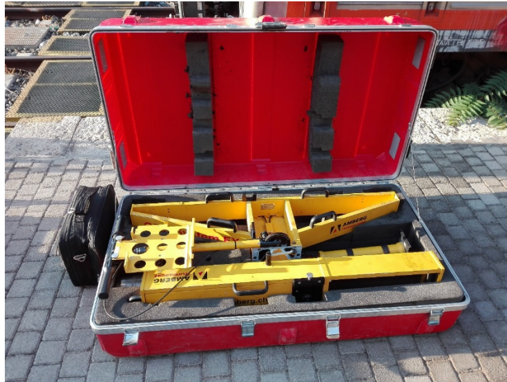
Εικόνα 3.1: Αποθήκευση του GRP χάρη στον αρθρωτό σχεδιασμό του
