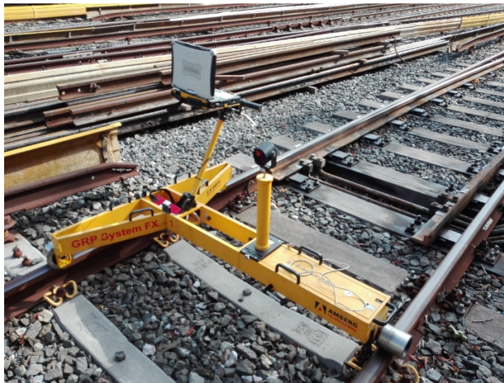
Εικόνα 3.2: Το σύστημα GRP 1000 έτοιμο για αποτύπωση γραμμής
