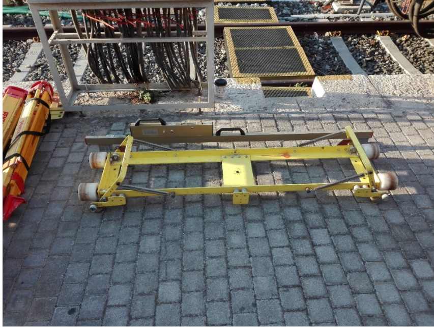
Εικόνα 3.9: Συμβατικό αμαξίδιο γραμμής και όργανα μέτρησης υπερύψωσης και εύρους γραμμής
