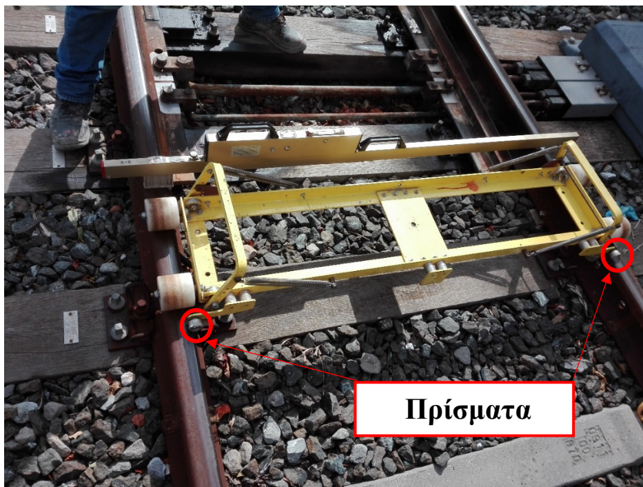
Εικόνα 3.12: Σύνολο οργάνων για την αποτύπωση γραμμής με τη μέθοδο του συμβατικού αμαξιδίου
