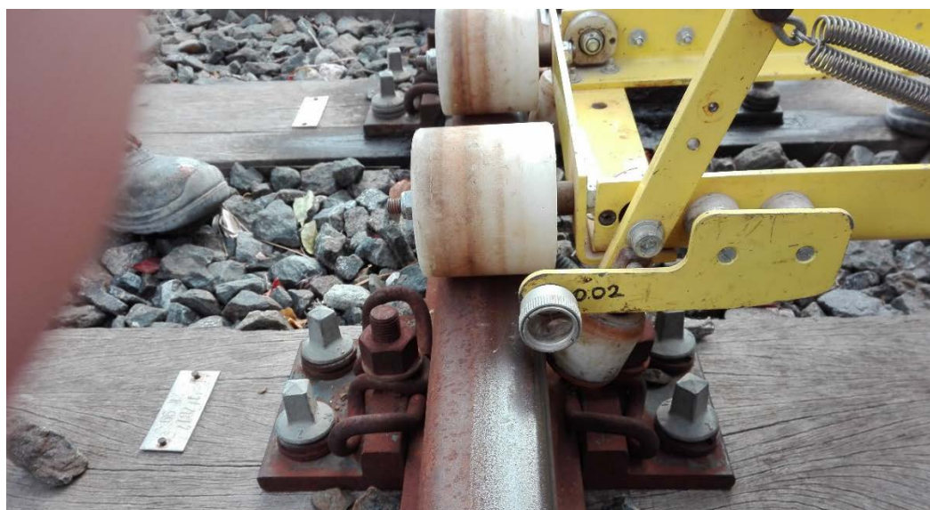
Εικόνα 3.13: Κατάφωτο σκόπευσης πακτωμένο σε σταθερή θέση πάνω στο αμαξίδιο
