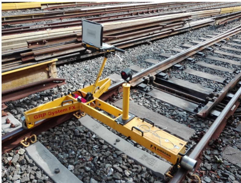
Εικόνα 2.3: Αποτύπωση σιδηροτροχιών με τη μέθοδο του τρόλεϋ GRP της εταιρίας Amberg Rail Technologies
