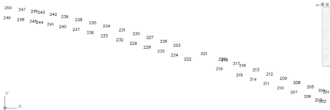
Εικόνα 5.7: Σημεία αποτύπωσης με τη μέθοδο της γωνιάς
