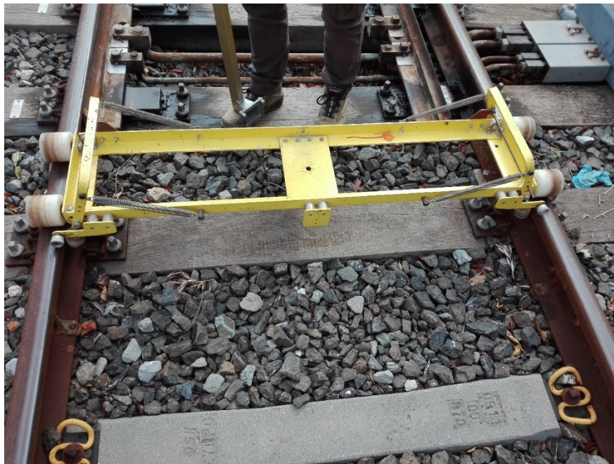
Εικόνα 3.10: Συμβατικό τρόλεϋ (αμαξίδιο) σε εργασίες αποτύπωσης σκυρογραμμής
