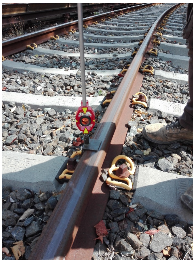
Εικόνα 4.15: Μέτρηση με τη μέθοδο της γωνιάς
