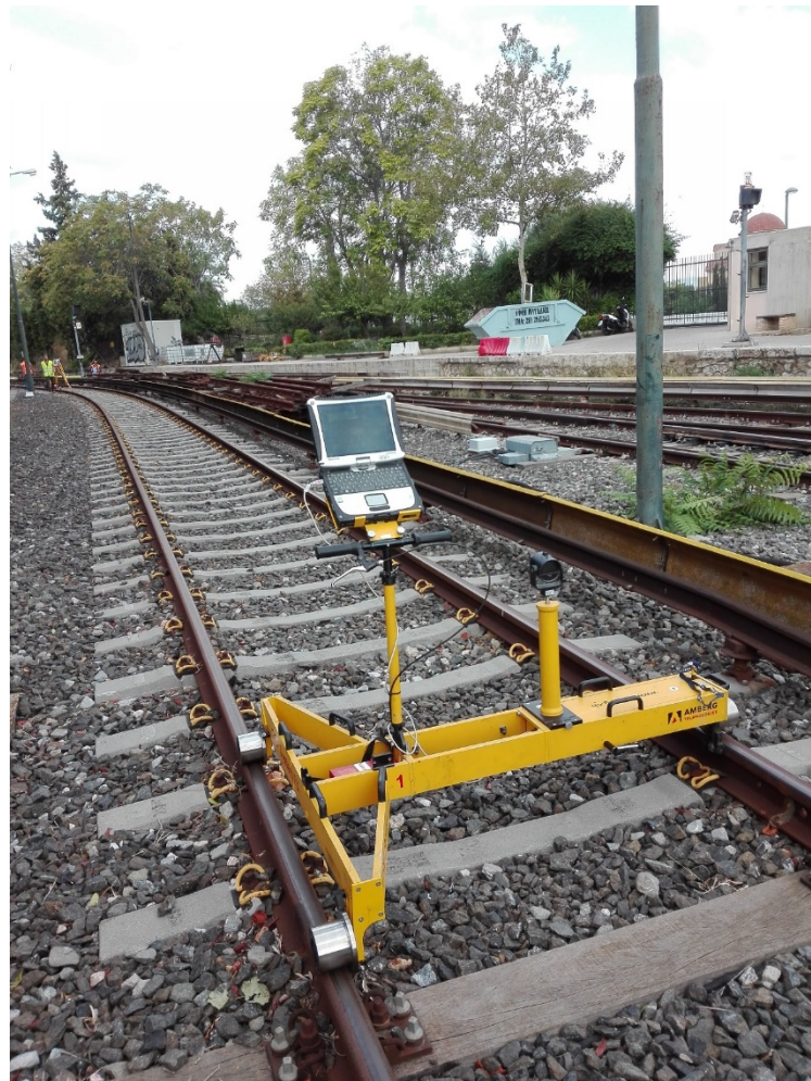
Εικόνα 2.10: Αμαξίδιο χάραξης-αποτύπωσης σιδηροτροχιών της εταιρίας Amberg Technologies
