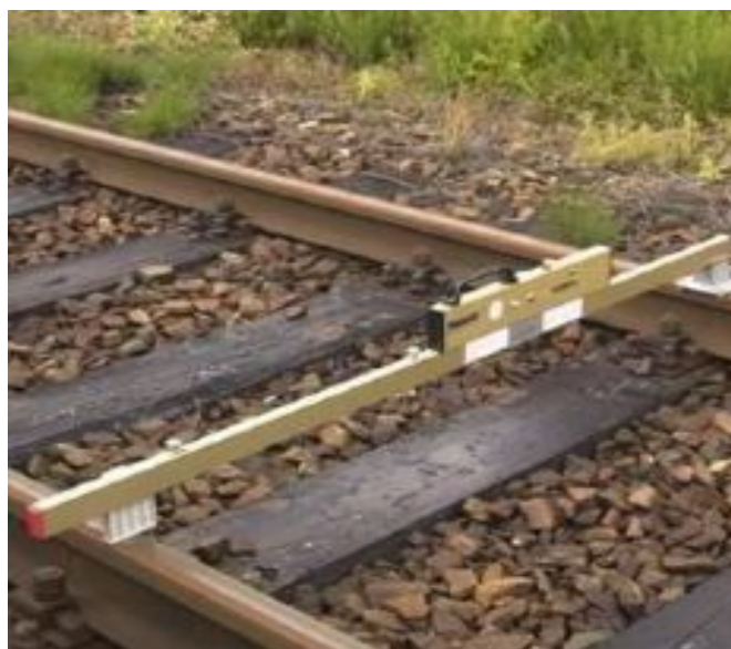
Εικόνα 2.1: Μετρητής εύρους γραμμής (gauge bar) και μετρητής υπερύψωσης γραμμής (το όργανο που βρίσκεται πάνω από τον μετρητή εύρους) της εταιρίας Robel [ www.robел.com ]
