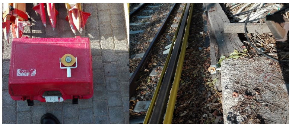
Εικόνα 4.9: Στόχοι για την πύκνωση του δικτύου με τη μέθοδο της ελεύθερης στάσης
