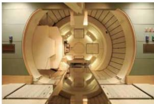
Εικόνα 6. 2: Ο ατσάλινος σκελετός περιστρέφεται και κατευθύνει τα πρωτόνια στον όγκο του ασθενούς. Η φωτογραφία προσφέρθηκε από το MD Anderson Proton Therapy Centre.
