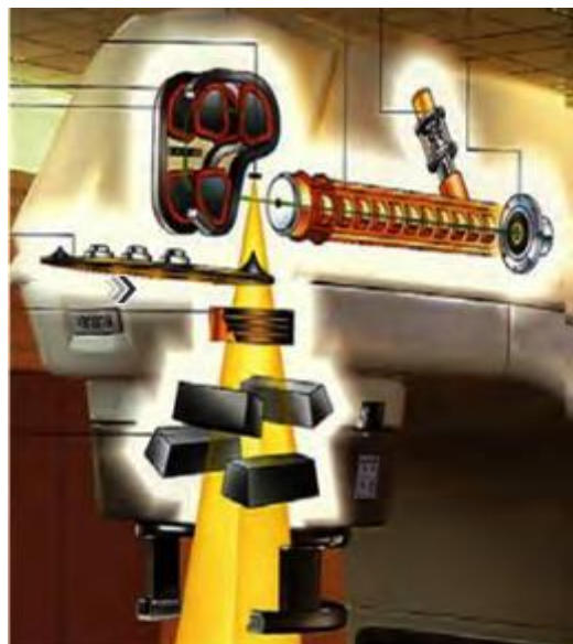
Εικόνα 5. 4: Το εσωτερικό μέρος ενός γραμμικού επιταχυντή [65]
