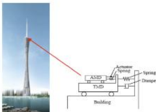
Σχήμα 1-8. Υβριδικός έλεγχος κτιρίου Guangzhou Tower (TMD+AMD)
