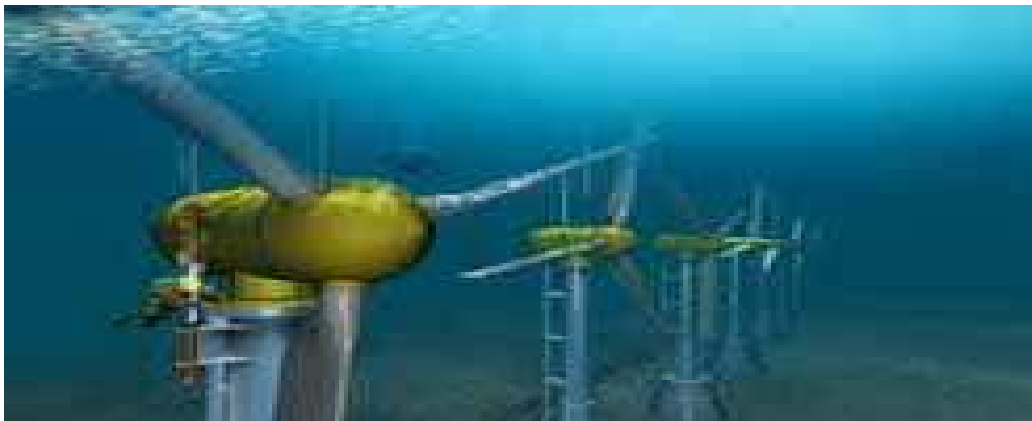
Εικόνα 4: Σύστημα οριζόντιου άξονα (Hammerfest Strøm)
