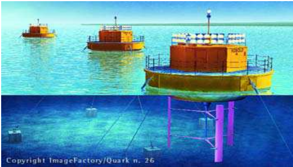
Εικόνα 5: Σύστημα κατακόρυφου άξονα (Enermar)
